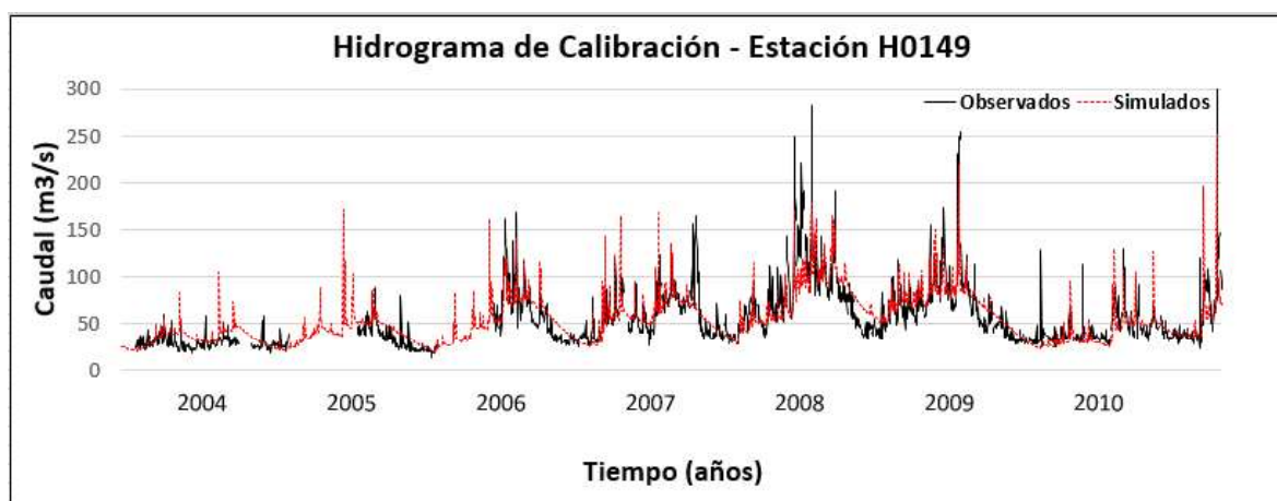
Figura 4.17: Hidrograma de calibración de la subcuenca delimitada por la estación H0149. Realizado por: Viviana Bravo
