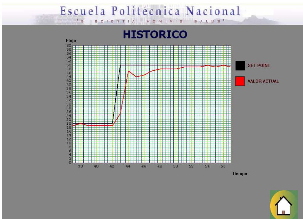
Figura 5.9. Valores de T_i=0.025 y T_d=0.003 , K_p 0.65 T_s = 7 [s].
