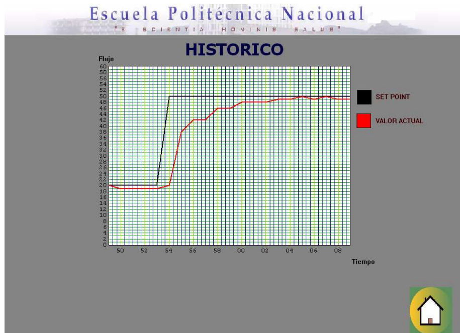
Figura 5.7. Valores de T_i=0.025 y T_d=0.0 , K_p=0.5 , T_s = 11 [s].
