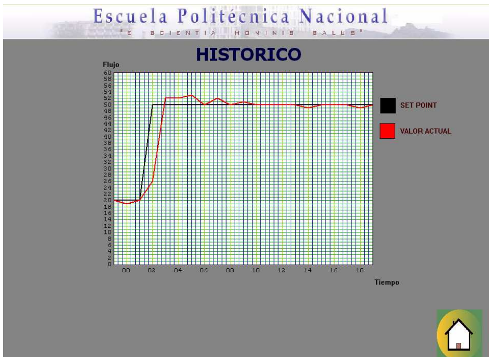
Figura 5.11 Valores de T_i=0.025 y T_d=0.042 , K_p 0.77 T_s = 6 [s].
