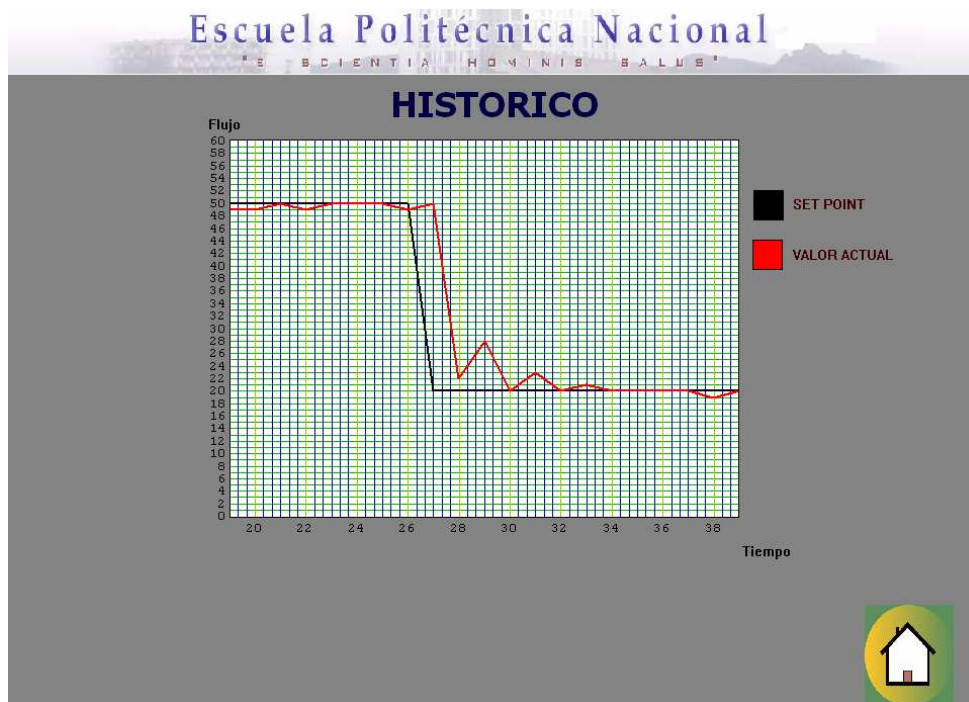
Figura 5.10 Valores de T_i=0.025 y T_d=0.0042 , K_p 0.77 T_s = 5 [s].
