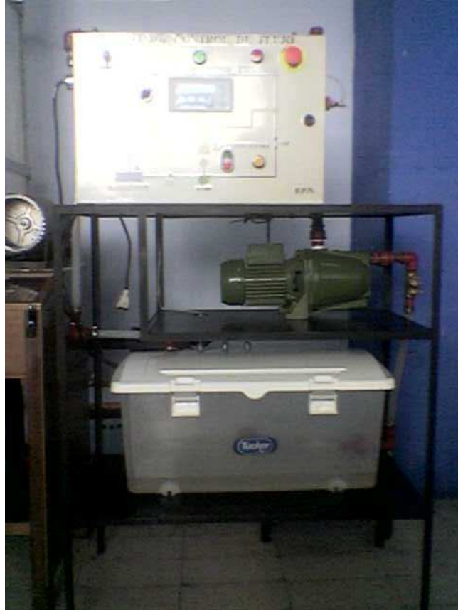
Figura 2.2 Soporte, tubería y panel de instrumentos del módulo de control de flujo.
