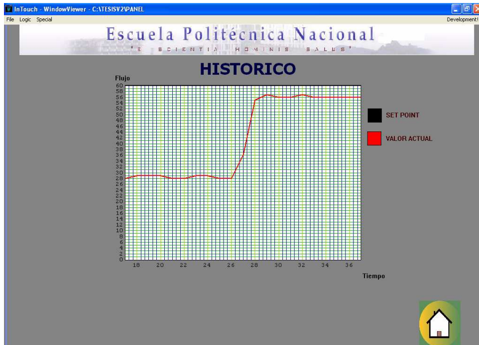
Figura 5.19 Flujo con control sobre el variador desde el BOP.
