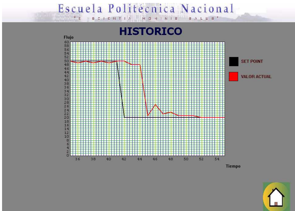
Figura 5.8 Valores de T_i=0.025 y T_d=0.003 , K_p 0.65 T_s = 7 [s].
