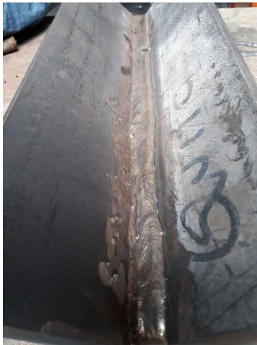
Figura 2.18. Fisura a lo largo de todo el cordón de soldadura en el tercer filete, Cruciform 1.
