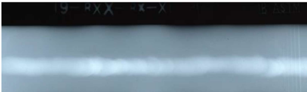
Figura 2.28. Placa radiográfica de la probeta 1 ensayo Varestraint .
