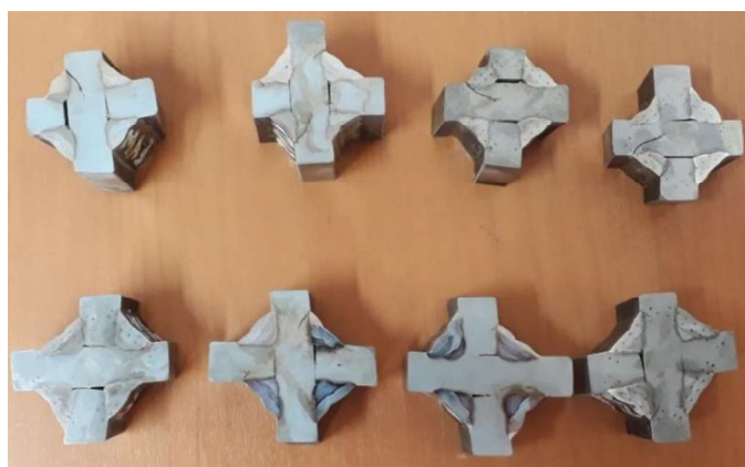
Figura 2.37. Probetas pulidas aplicadas el ataque químico del ensayo Cruciform .
