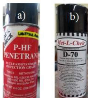
Figura 2.23. Líquidos utilizados para ensayo de tintas penetrantes. (a) Penetrante, (b) revelador. (Fuente: propia)
