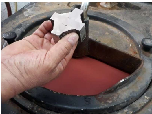
Figura 2.35. Proceso de desbaste grueso realizado a una probeta del ensayo Cruciform . (Fuente: propia)
