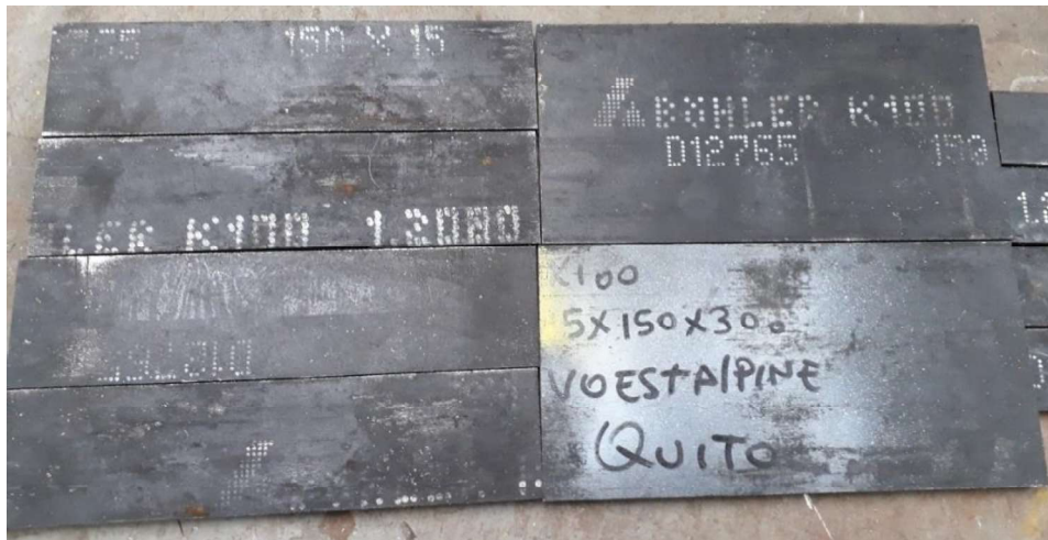
Figura 2.14. Material base cortado según dimensiones del ensayo Cruciform . (Fuente: propia)
