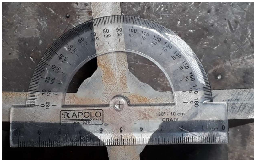
Figura 3.11. Distorsión del ensamble Cruciform 2 .
