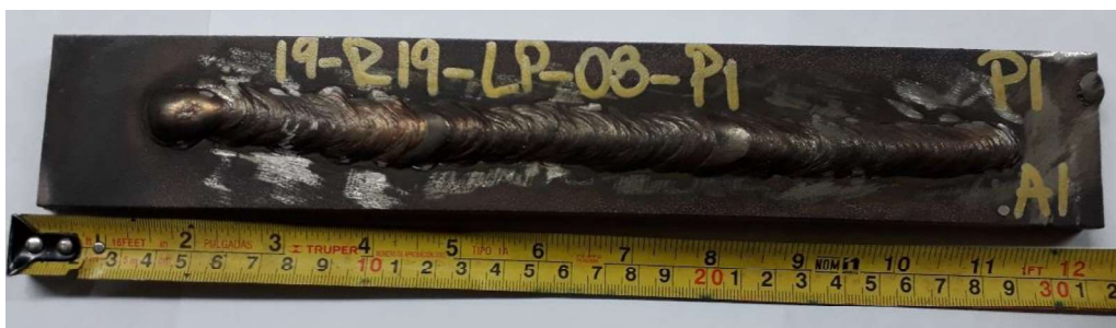
Figura 2.21. Inspección e interpretación de las discontinuidades presentes en la probeta 1, del ensayo Varestraint por inspección visual.
