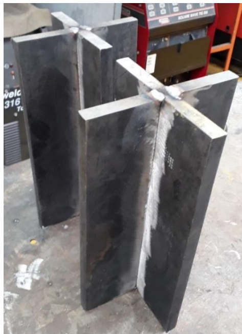
Figura 2.15. Ensamble de las probetas ensayo Cruciform . (Fuente: propia)
