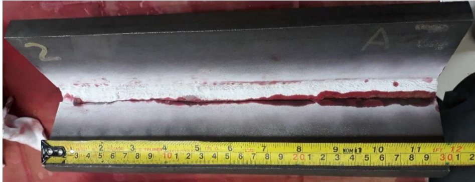
Figura 2.27. Inspección e interpretación de las discontinuidades presentes en el tercer filete del Cruciform 1 por tintas penetrantes.
