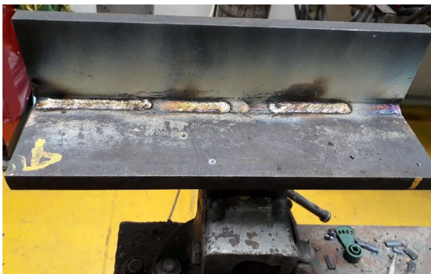
Figura 2.16. Cordón de soldadura depositado en posición 2F ensayo Cruciform . (Fuente: propia)
