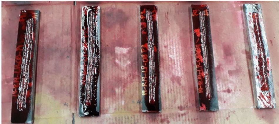
Figura 2.24. Aplicación por aspersion del líquido penetrante en las probetas del ensayo
