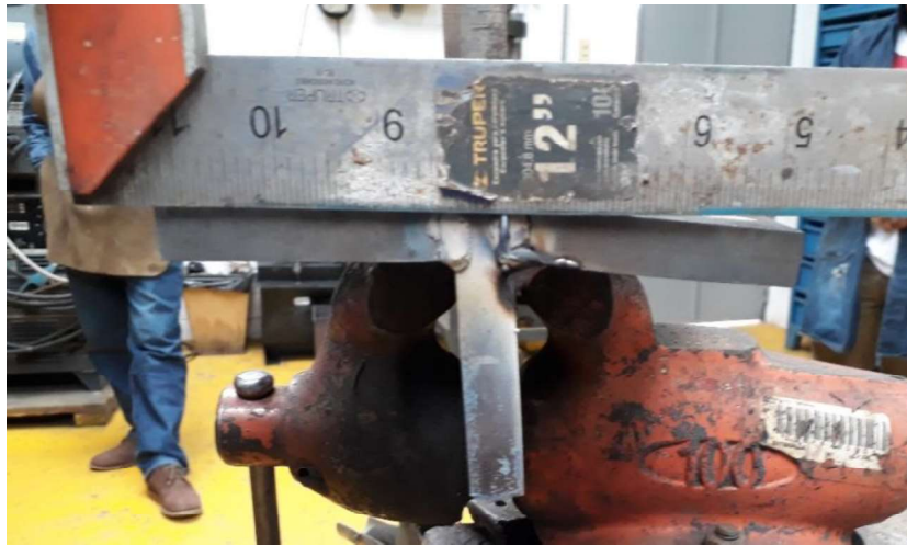
Figura 2.17. Expansión térmica angular ensayo Cruciform .
