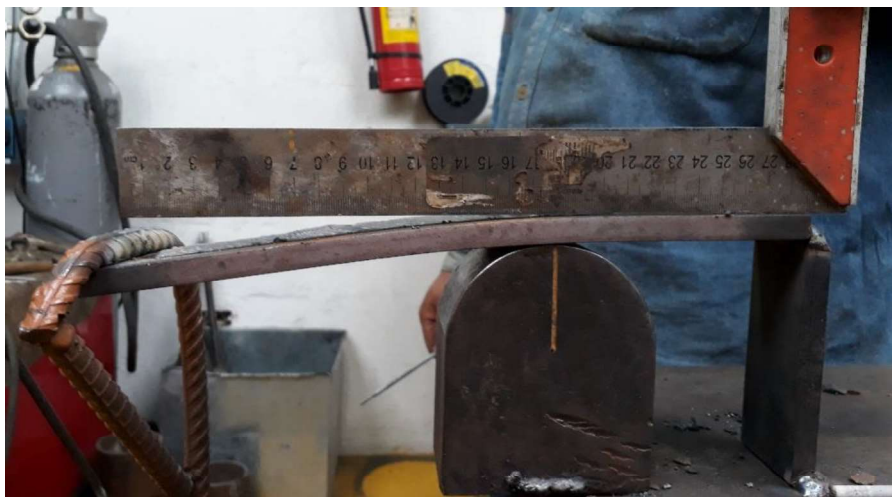
Figura 2.13. Probeta deformada, el enfriamiento se llevó a cabo con la fuerza de doblado aplicada. (Fuente: propia)
