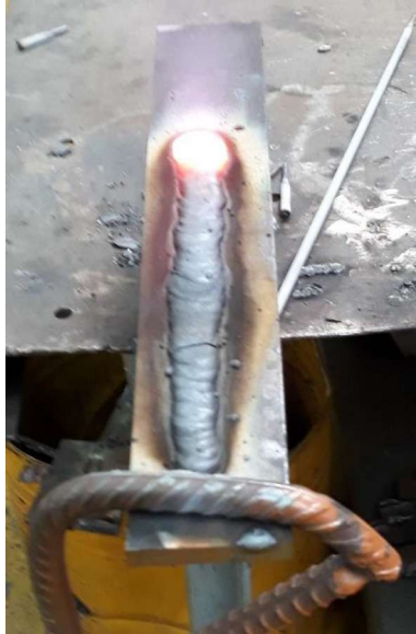
Figura 2.12. Cordón de soldadura depositado en posición 1G ensayo Varestraint . (Fuente: propia)
