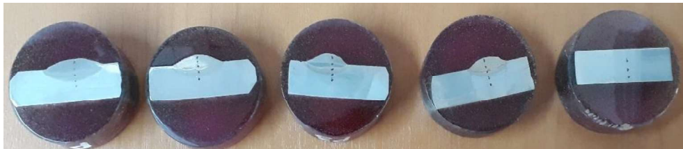
Figura 2.33. Probetas del ensayo Varestraint pulidas y aplicadas el ataque químico y probeta pulida del material base.
