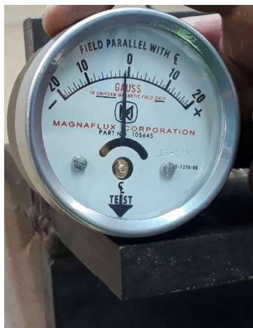
Figura 2.29. Medición del campo magnético residual (Fuente: propia)
