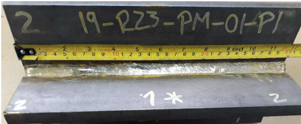
Figura 2.30. Inspección e interpretación de las discontinuidades presentes en el tercer filete del Cruciform 1 por partículas magnéticas.
