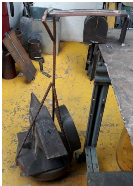
Figura 2.10. Aplicación de la fuerza de doblado sobre una probeta en el ensayo Vareststraint . (Fuente: propia)
