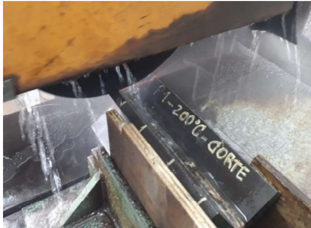
Figura 2.34. Corte transversal con enfriamiento con agua de la probeta Cruciform 1 . (Fuente: propia)
