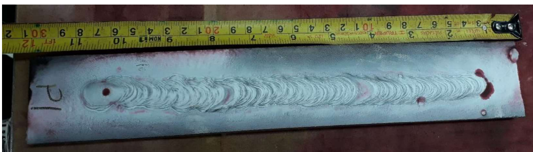
Figura 2.25. Inspección e interpretación de las discontinuidades presentes en la probeta 1 del ensayo Varestaint por tintas penetrantes.
