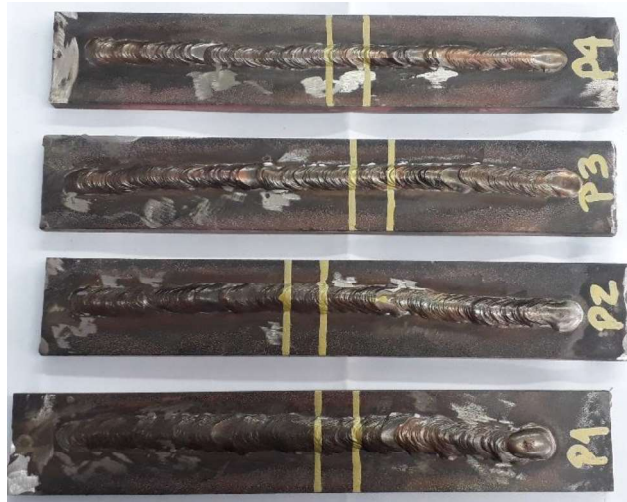
Figura 2.31. Extracción de las probetas, secciones de corte del ensayo Varestraint .
