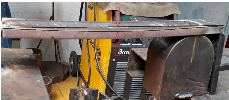
Figura 2.9. Expansión térmica angular opuesta a la dirección del peso aplicado en probeta ensayo Vareststraint . (Fuente: propia)
