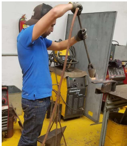
Figura 2.11. Proceso de precalentamiento utilizando una llama de oxiacetilénica.
