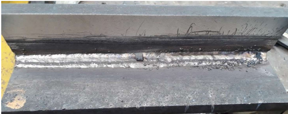
Figura 2.19. Soplo magnético en el tercer filete Cruciform 2 . (Fuente: propia)
