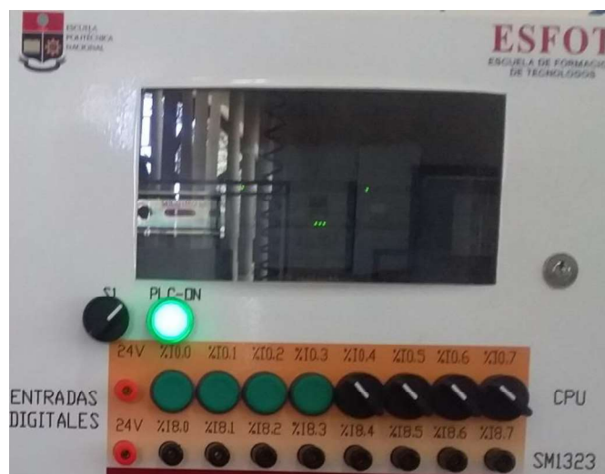
Figura 3.72: Encendido del módulo PLC.
