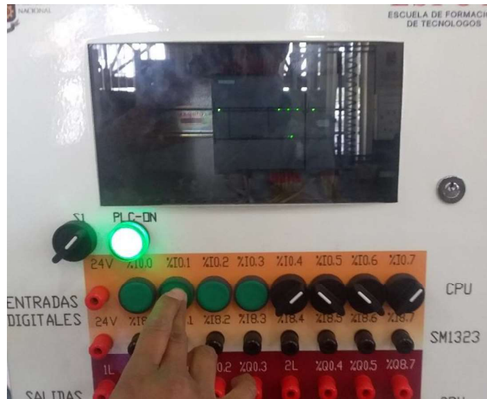
Figura 3.73: Accionamiento de las entradas digitales.
