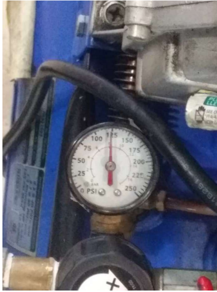
Figura 3.67: Carga máxima del compresor.
