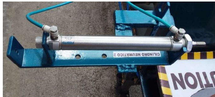
Figura 3.49: Cilindro 2 para empujar la caja.
