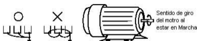
Figura E1.2: Conexión de giro antihorario. [18]
