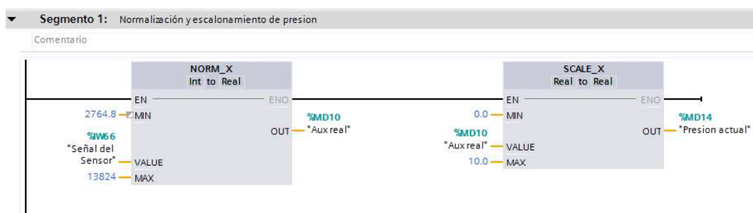
Figura 3.57: Normalización y escalamiento para la señal analógica.
