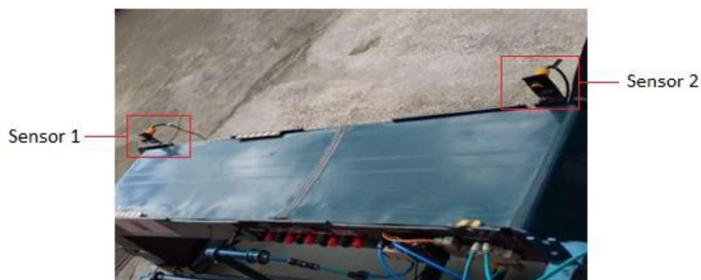
Figura 3.47: Ubicación de los sensores de proximidad.
