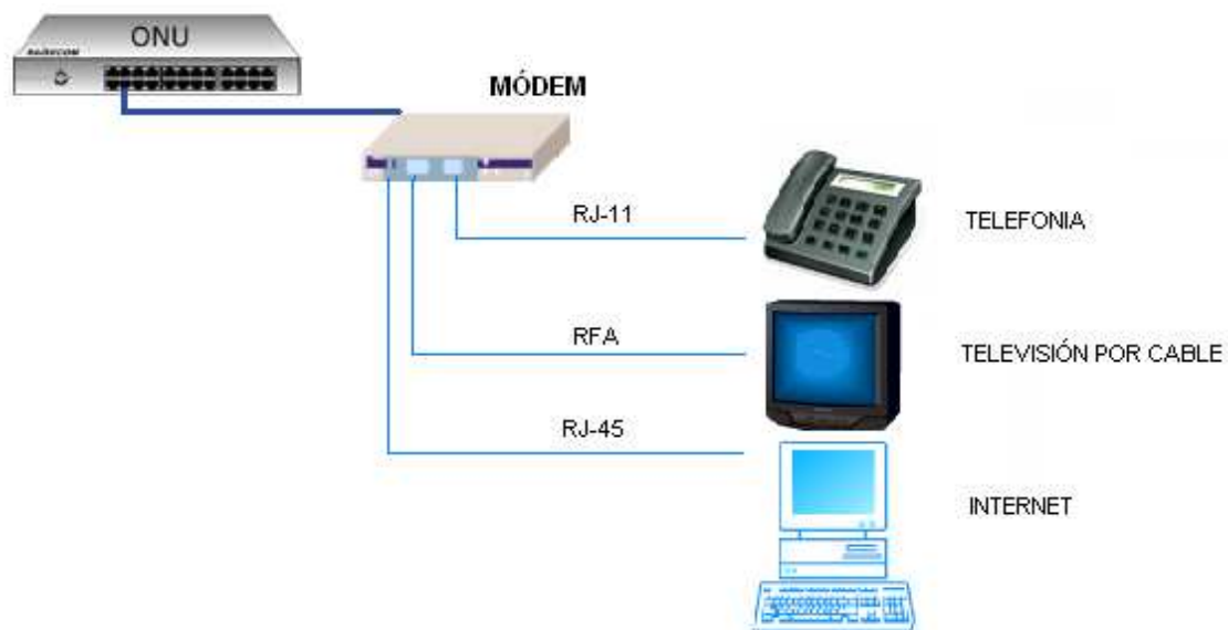
Figura 3.13: Conexión entre la ONU y el equipo final de usuario
