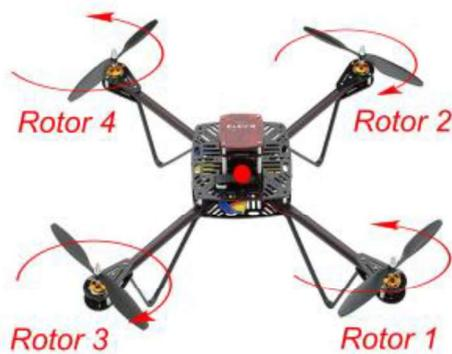
**Figura 1.4** Movimiento de las hélices de un cuadricóptero.
