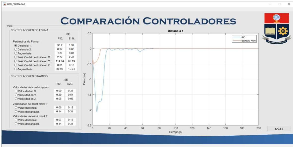
**Figura 2.23** Pantalla de comparación de controladores del seguimiento de trayectoria.
