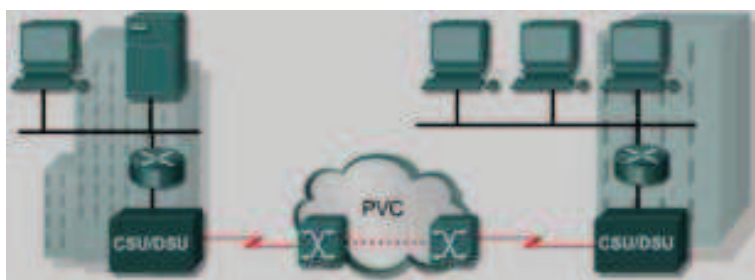
Figura No. 2.15 Diagrama típico de una red Frame Relay 18
