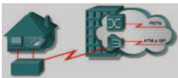
Figura No. 2.17 Diagrama típico de una red DSL 19
