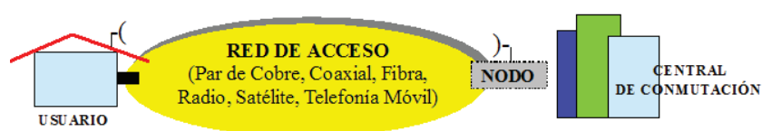
Figura No. 2.13 Diagrama típico de una red de acceso
