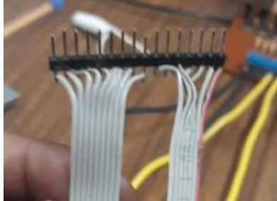
Figura 3.27. Cable AWG 28 soldado a los espadines tipo macho. (Fuente: Propia)
