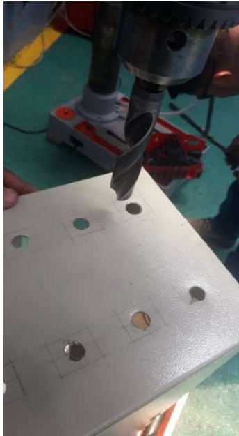
Figura 3.11. Trazos y perforación del tablero metálico. (Fuente: Propia)
