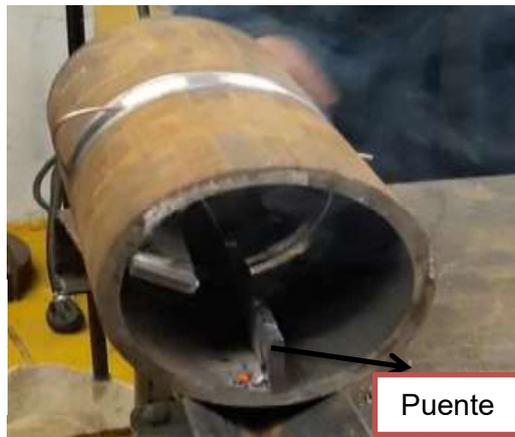
Figura 2.11. Colocación de los puentes.
