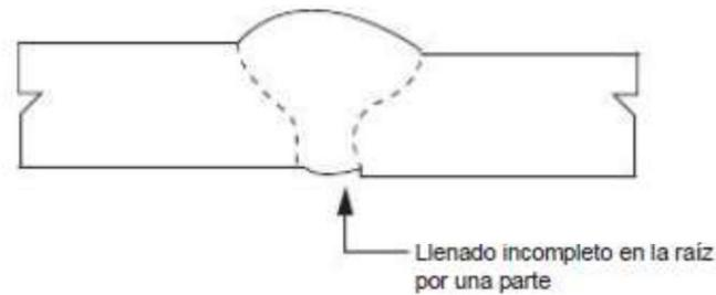
Figura 1.3. Penetración incompleta debido a desalineación.
