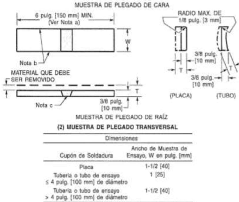
Figura 2.7. Dimensiones de las probetas de doblado de cara y raíz.
