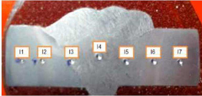
Figura 3.4. Indentaciones de la junta soldada.
