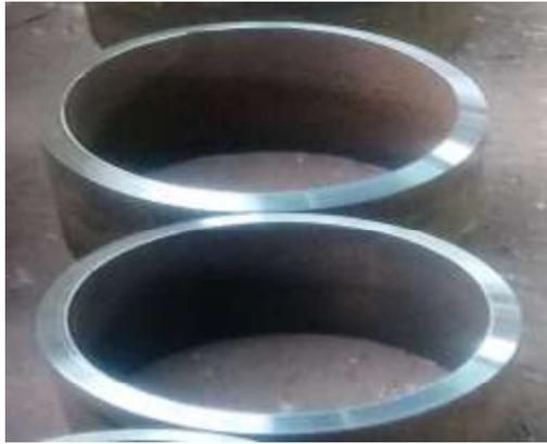
Figura 2.10. Preparación de la junta a soldar.
