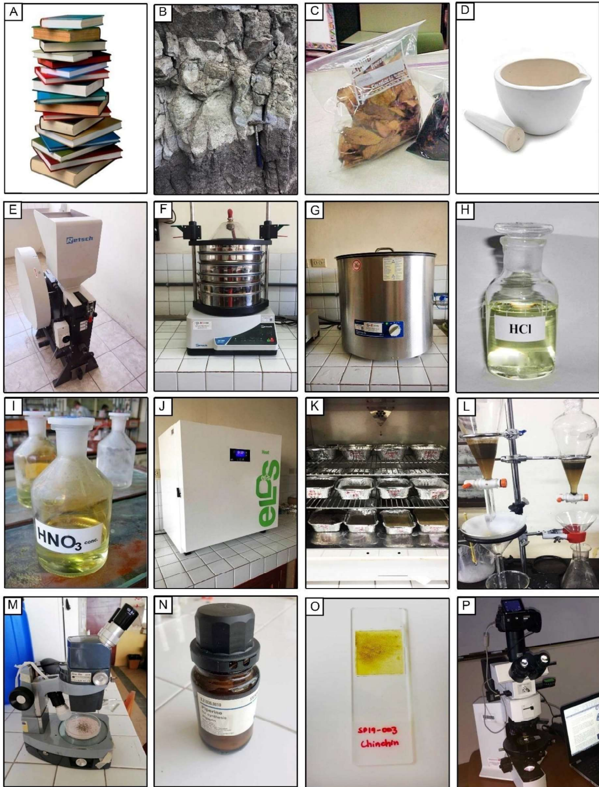
Figura 33. Guía cronológica para la realización de los pasos de la metodología. A. Recopilación bibliográfica. B. Visita del afloramiento. C. Muestreo. D. Trituración manual. E. Trituración mecánica. F. Tamizado. G. Limpieza de tamicas. H. Ataque con ácido clorhídrico. I. Ataque con ácido nítrico. J-K. Secado de las muestras en el horno. L. Separación de minerales por líquidos pesados en peras de separación. M. Análisis en el binocular. N-O. Polvo de piperina para el montaje de la lámina delgada. P. Conteo modal de minerales pesados en el microscopio.
