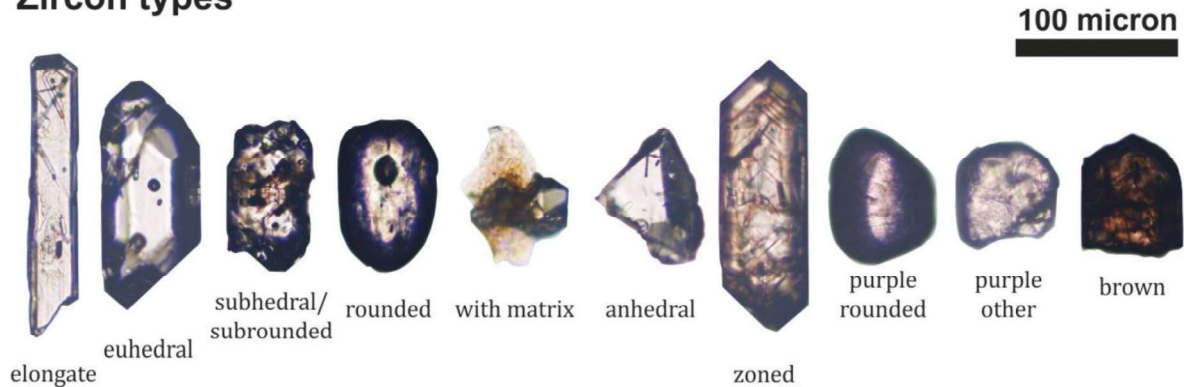
Figura 32. Morfología de los cristales de circón observados bajo el microscopio. Nótese los granos euhedrales, que indican granos más jóvenes o tiempo limitado en un sistema de transporte de sedimentos, y granos bien redondeados que indican tiempo prolongado en un sistema de transporte.
