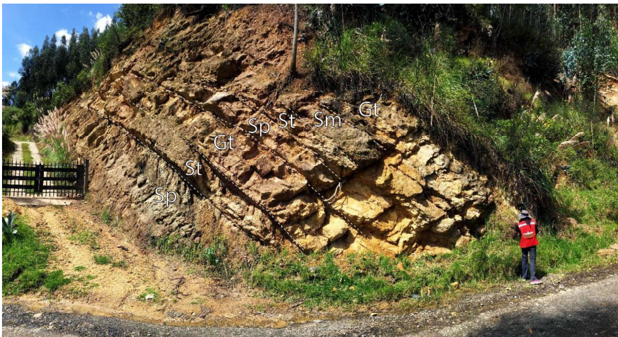
Figura 20. Secuencias de barras y canales de conglomerados y areniscas de grano medio a grueso con estratificación cruzada planar, las capas presentan una dirección N7E/50SW (UTM: 733440/9698675).
