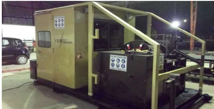
Figura 2.30. Unidad de Wireline Ves Survey Fuente. (INFLEX, 2016)
