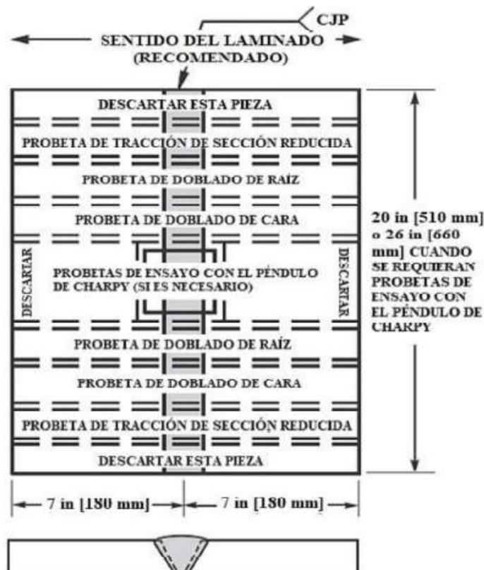
Figura 2.10. Extracción de las probetas según los ensayos.
