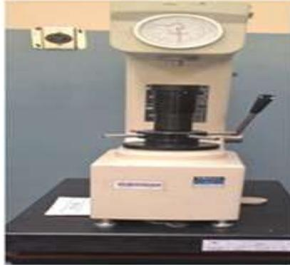
Figura 2.4. Durómetro Rockwell LAEV.
