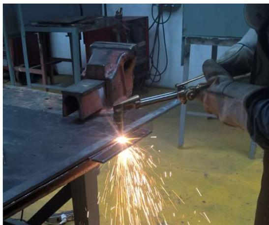
Figura 2.5. Proceso de corte del acero anti abrasivo mediante oxicorte.
