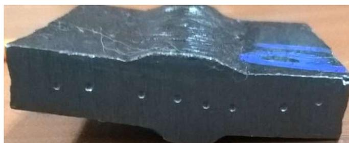
Figura 2.19. Representación esquemática de las mediciones de dureza.
