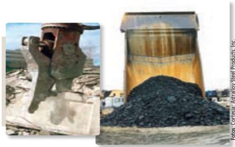
Figura 1.4. Aplicación de acero anti abrasivo.
