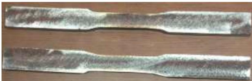
Figura 2.2. Probetas para ensayo de tracción.
