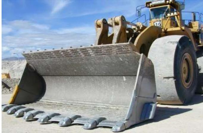
Figura 1.6. Cucharón de excavadora fabricado de acero anti abrasivo.
