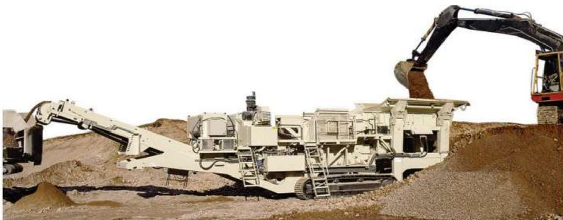
Figura 1.5. Máquina trituradora.
