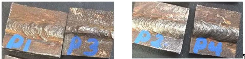
Figura 2.18. Muestras para el ensayo de barrido de dureza superficial.
