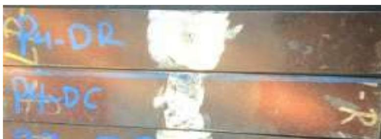
Figura 2.16. Probeta de ensayo de doblado y mecanizada.
