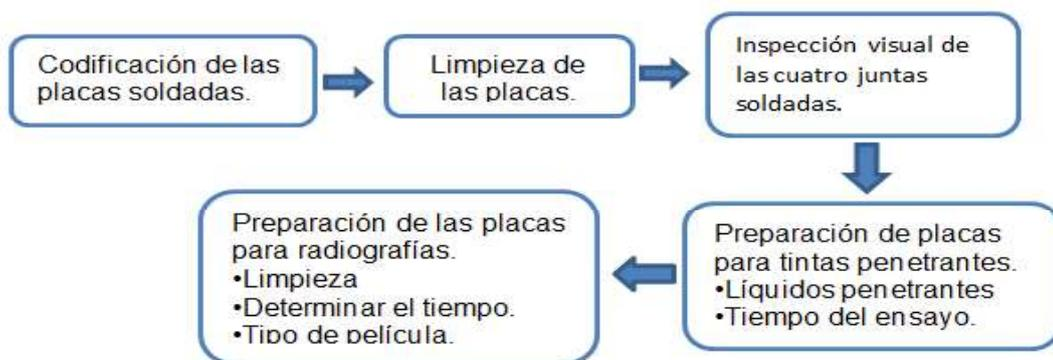
Figura 2.7. Diagrama de proceso para los ensayos no destructivos (END).
