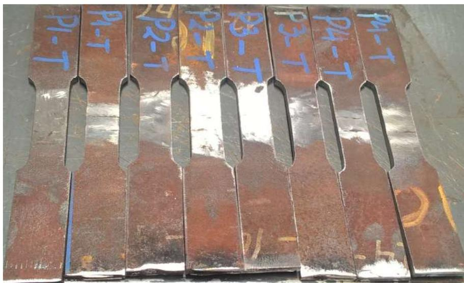
Figura 2.15. Probetas maquinadas y adecuadas para el ensayo.
