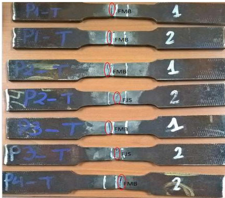
Figura 3.5. Probetas luego del ensayo de tracción.
