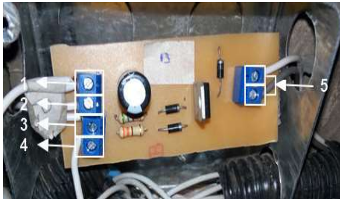
Figura 3.31: Líneas de conexión de la tarjeta
