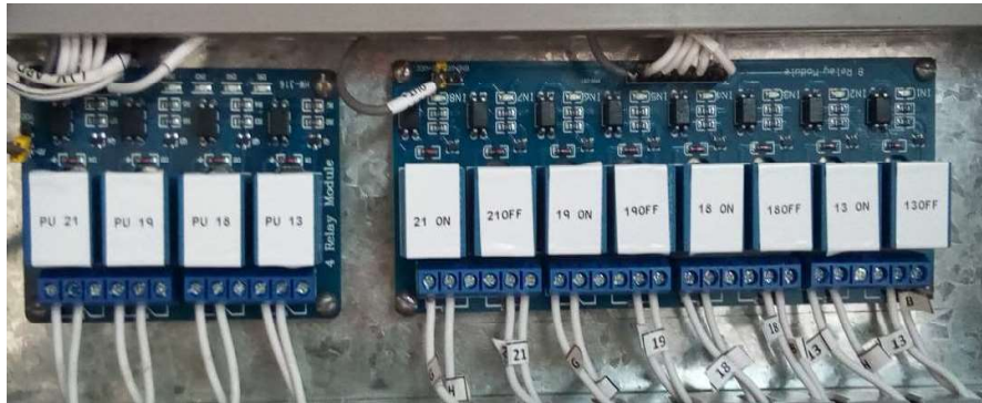
Figura 3.15: Conexión de los módulos relé
