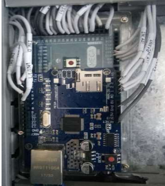
Figura 3.13: Conexiones realizadas de la tarjeta Arduino Mega
