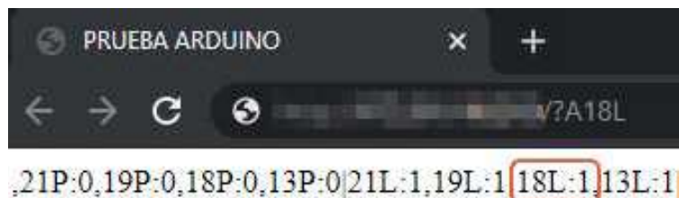
Figura 3.53: Estado del sensor luminarias apagadas
