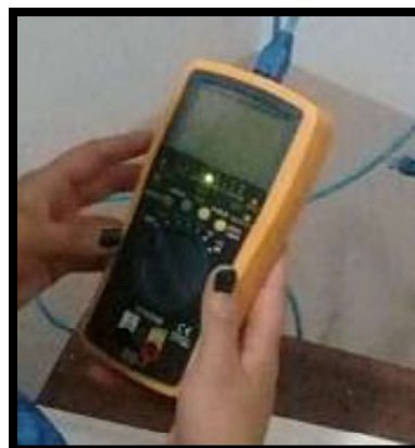
Figura 14. Cable etiquetado y test de ponchado
