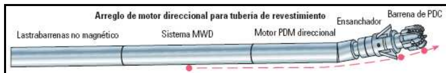
Figura 4.5: Motor direccional para perforación con casing 1 Fuente: Tesco.
