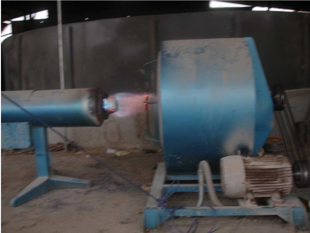
Figura 3.2 Secador circular de 8 m de diámetro en funcionamiento.
