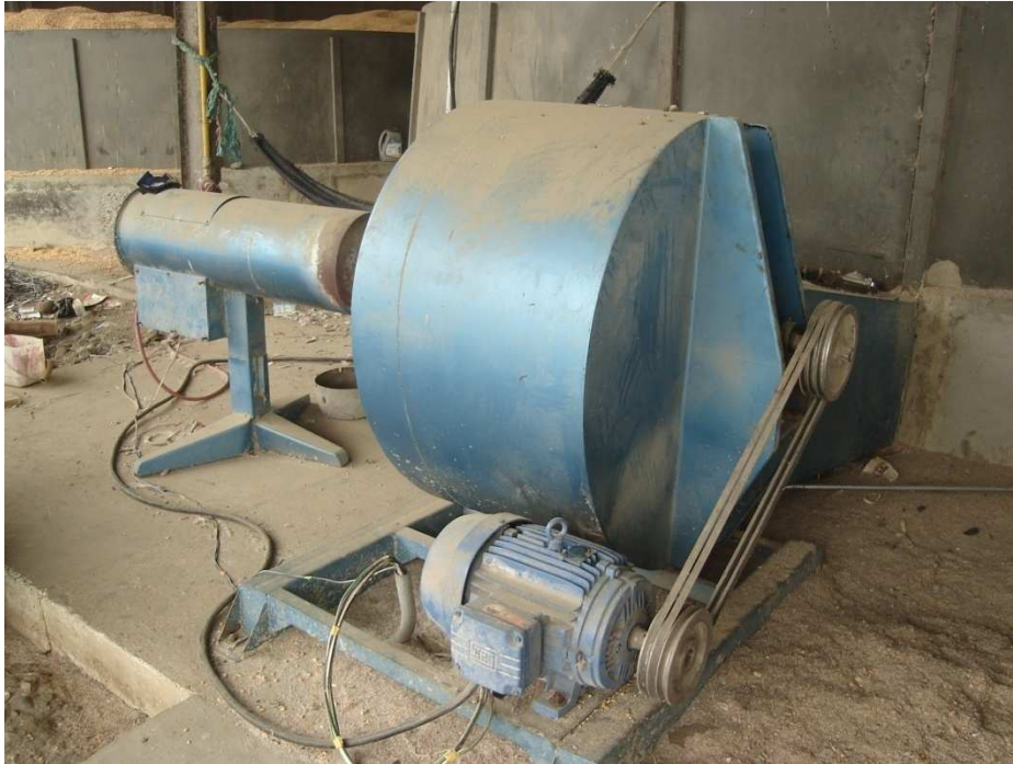
Figura 3.7 Configuración actual de la distribución del aire de secado en el secador circular (sin expansión gradual).
