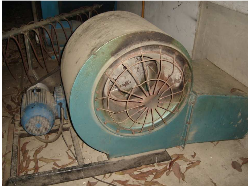
Figura 3.15 Configuración actual de la distribución del aire de secado en el secador rectangular (sin expansión gradual).
