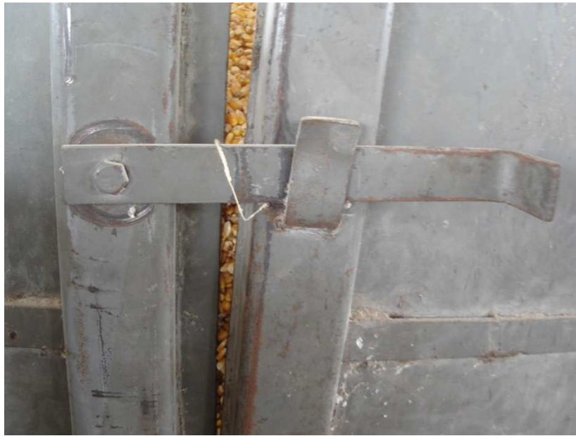
Figura 3.18 Puerta del secador pandeada
