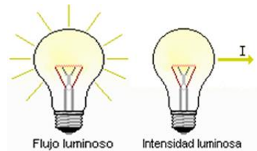
Figura 1.20. Diferencia entre flujo luminoso e intensidad luminosa.
