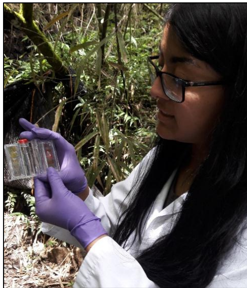
Figura 16. Medición Cloro Residual
