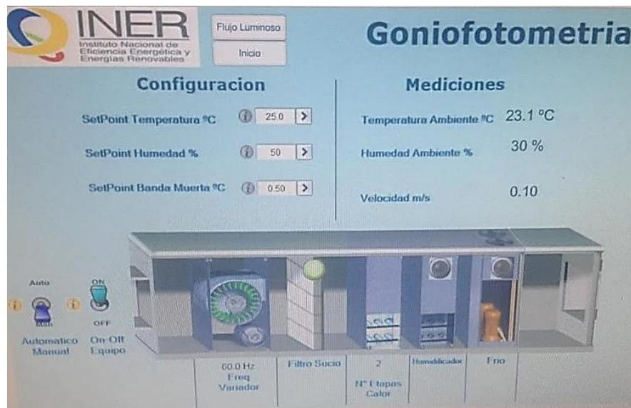
**Figura 2.8** Sistema de climatización del laboratorio
