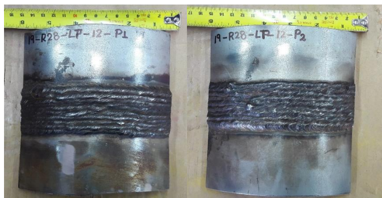
Figura 2.12. Probetas para el ensayo de tintas penetrantes.
