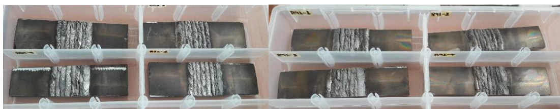
Figura 2.18. Probetas después del ensayo de corrosión.
