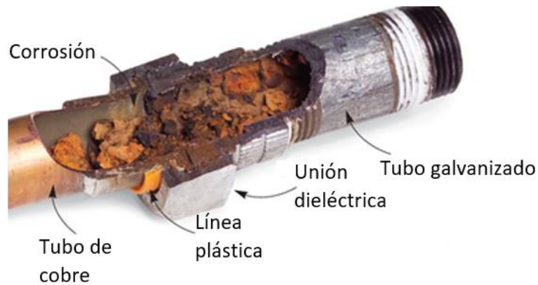
Figura 1.26. Corrosión galvánica.
