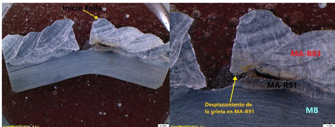
Figura 3.7. Macrografía del ensayo de doblado transversal en la configuración R-91+B-83, inicio de falla y fisuras a 4X y 10X.
