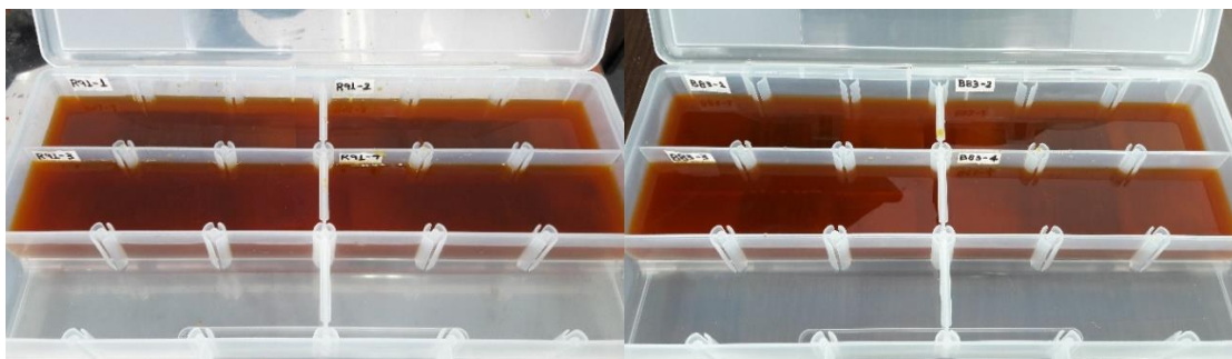
Figura 2.17. Probetas sumergidas en la solución de cloruro férrico.
