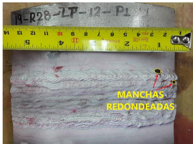
Figura 3.23. Discontinuidades mostradas en el ensayo de tintas penetrantes a la configuración R-91+B-83. (Fuente: Propia)
