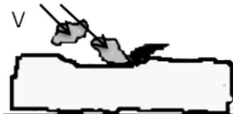
Figura 1.19. Abrasión por erosión.
