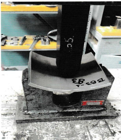
Fotografía 1. Ensayo de doblado transversal.
