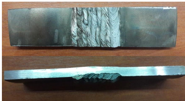
Figura 3.28. Probetas después del ensayo de corrosión.
