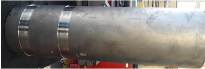
Figura 2.3. Tubería con el acanalado.
