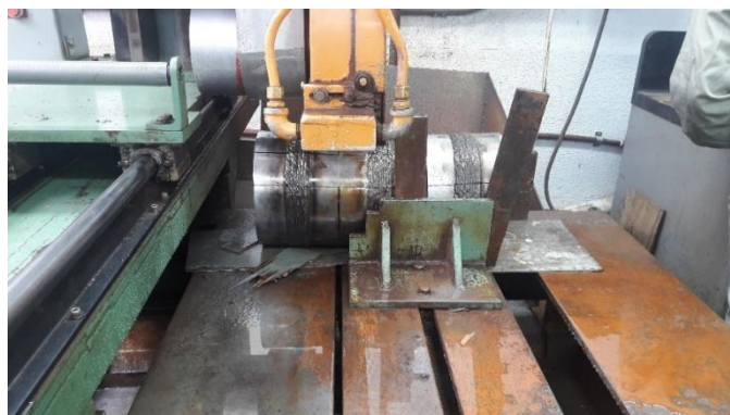
Figura 2.10. Tubería acoplada en la cortadora.
