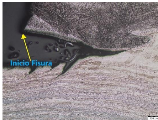
Figura 3.17. Puntos de inicio de fisura en doblado transversal en la configuración R-91+B-83 a 100X.
