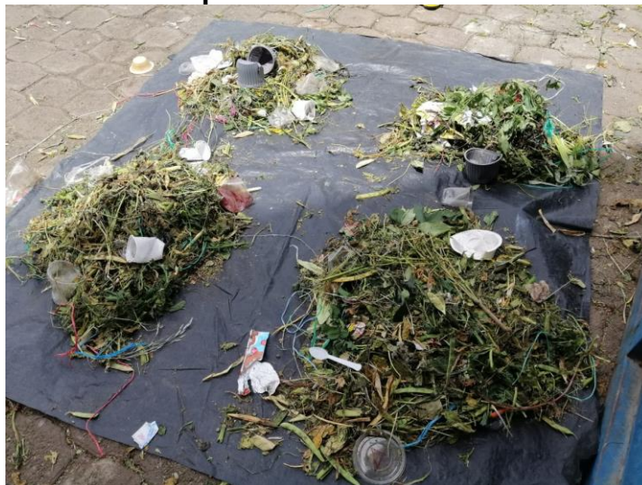
Figura 9. Método de cuarteo para la caracterización de los residuos.
