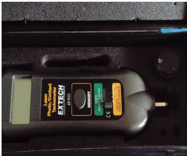
**Fig. 3.18 Tacómetro**
