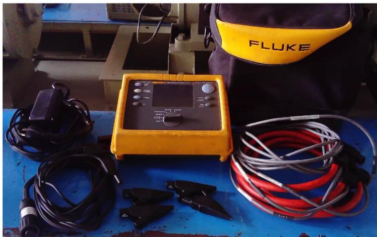
**Fig. 3.16 Analizador de Red Fluke 1735**
