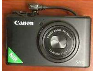
Fig. 3. 28 Cámara tipo Canon S110 NIR.
