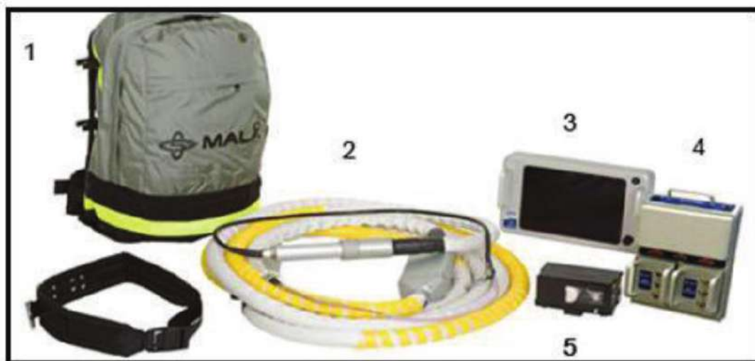
Fig. 3. 12 Equipo completo del Georadar de suelo. 1. Mochila 2. Antenas 3. Pantalla 4. Unidad de control 5. Hilo para medir distancia. Tomado de (Zapata, 2015).
