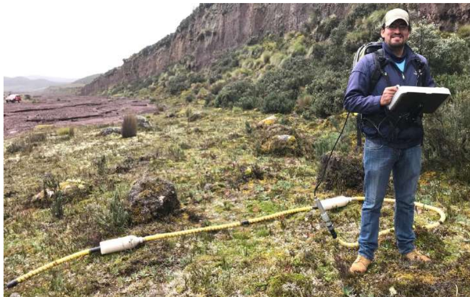
Fig. 3. 13 Equipo GPR, instalación del equipo y transporte adaptado a una mochila en la Q. Jatabamba.
