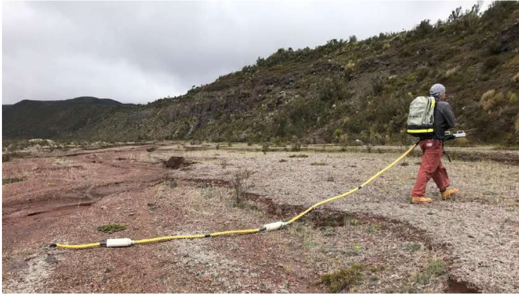
Fig. 2. 12 Equipo GPR en la Quebrada Pucarumi. En ella se pueden observar las partes del equipo como: mochila, las antenas, la pantalla y el equipo de control que se encuentra dentro de la maleta.
