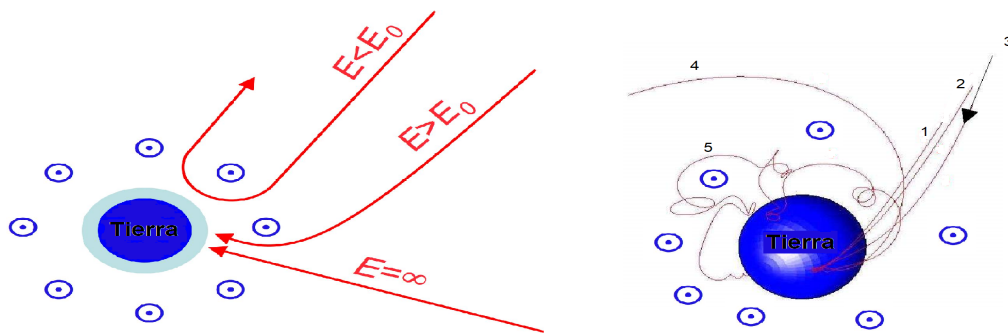
Figura 1.1: Trayectoria de una astropartícula atrapada por el campo magnético de la Tierra. La figura izquierda presenta las trayectorias de las partículas para determinadas energías donde E_0 será la energía mínima. La figura de la derecha presenta las astropartículas que cambian de trayectoria debido a la energía que llevan [1].
