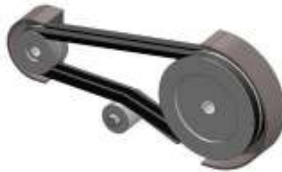
Figura 2.10. Embrague por tensor (Fuente: Propia)
