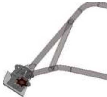
Figura 2.18. Mecanismo de posicionamiento angular (Fuente: Propia)
