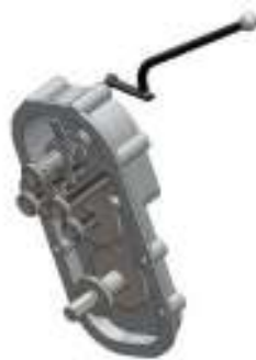
Figura 2.12. Tren de engranajes (Fuente: Propia)
