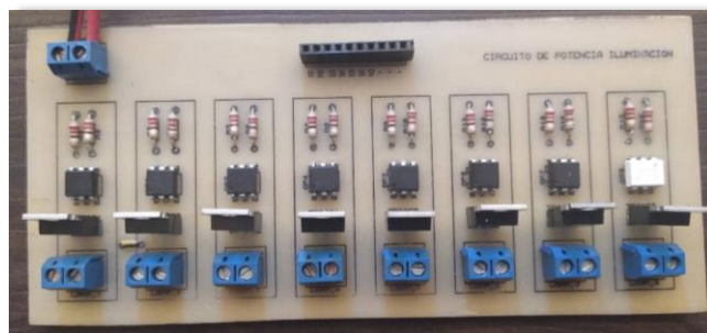
Figura 111. Placa de circuito impreso PCB para potencia de iluminación
