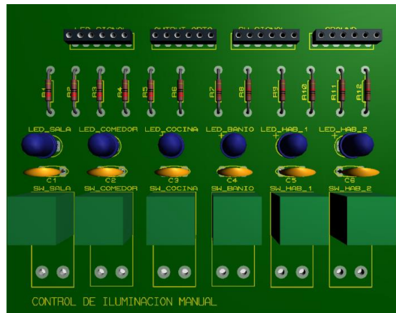
Figura 57. Previsualización del PCB para control de iluminación.
