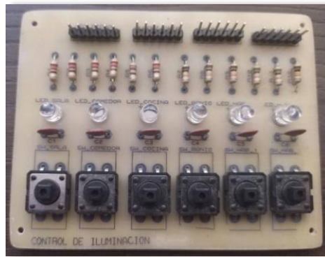
Figura 112. Placa de circuito impreso para control de lámparas
