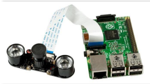
Figura 114. Instalación de la cámara en Raspberry Pi
