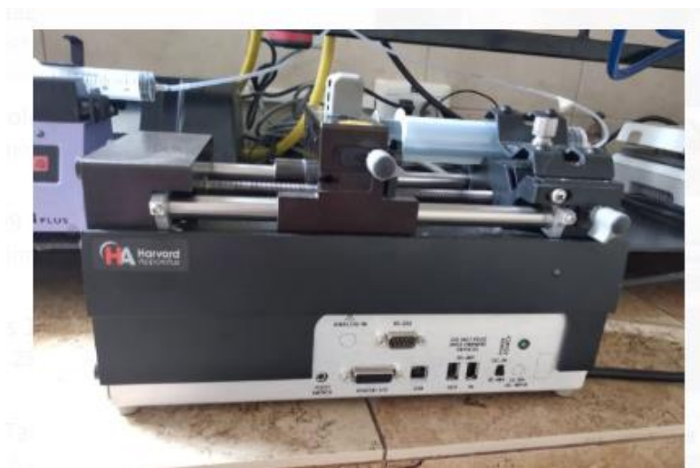
Figura1.5. Bomba de dosificación Harvard Apparatus (Fuente: Propia)
