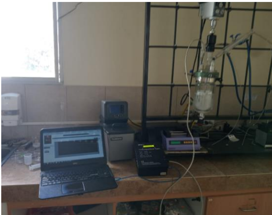
Figura 2.17. Sistema de monitoreo instalado con el reactor. (Fuente: Propia)
