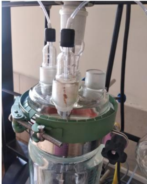
Figura1.10. Tapa del reactor de polímeros del CIAP (Fuente: Propia)
