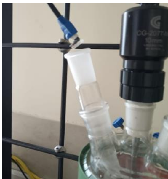
Figura 2.11. Adaptador de teflón entre el sensor y adaptador de vidrio. (Fuente: Propia)
