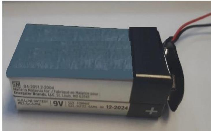
Figura 2.37. Fuente de alimentación para Arduino uno, batería de 9 voltios.
