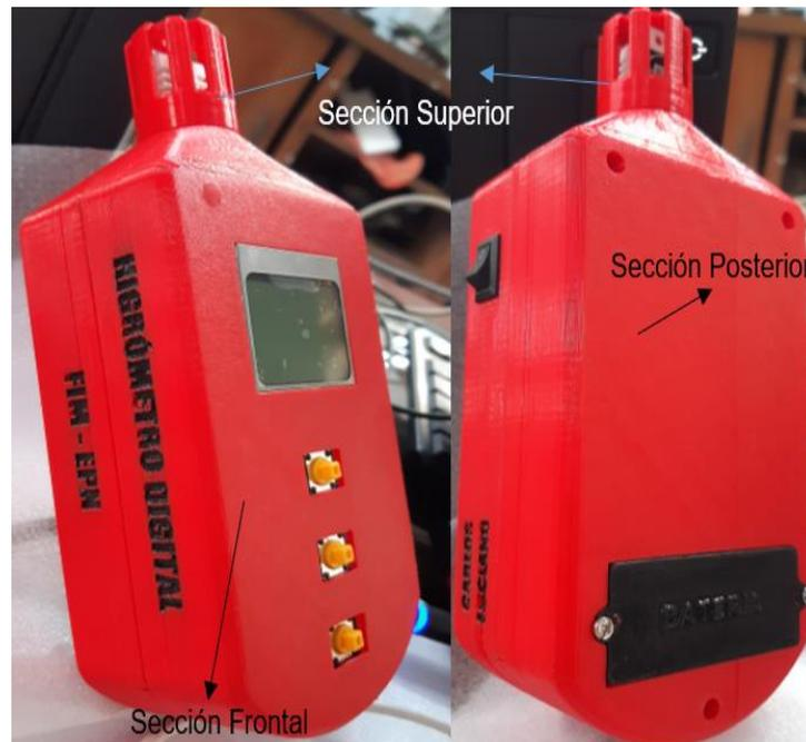
Figura 2.41. Partes del higrómetro digital.
