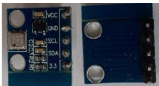
Figura 2.4. Sensor BMP180 estado físico.
