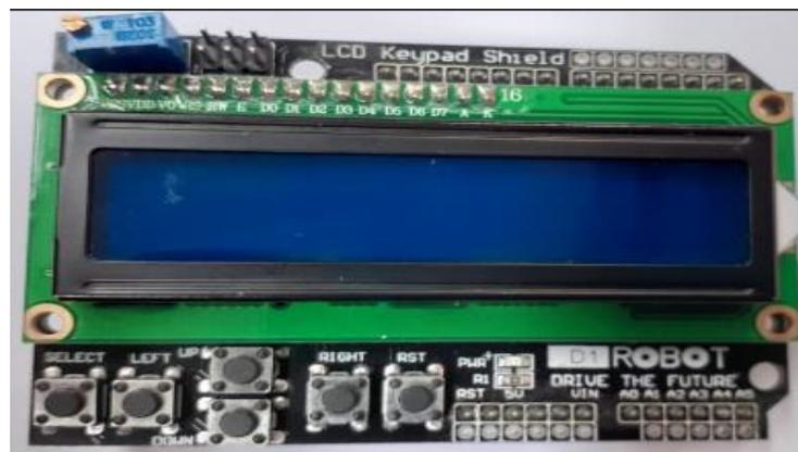
Figura 2.5. Pantalla LCD 1602 forma física.
