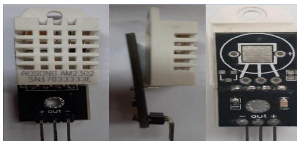
Figura 2.3. Sensor AM2302, estructura física.
