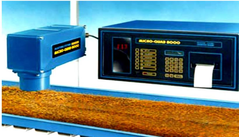
Figura 1.11. Higrómetro de absorción infrarroja.
