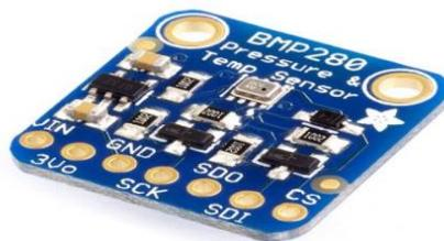
Figura 1.19. Sensor BMP280 para Arduino.
