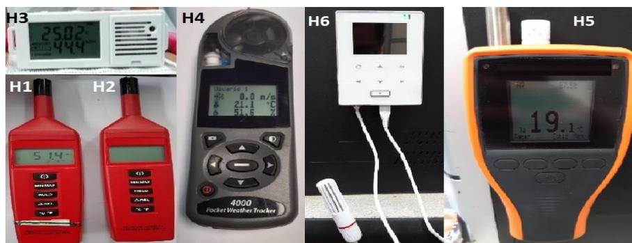
Figura 2.2. Higrómetros digitales utilizados en la toma de datos de este proyecto.
