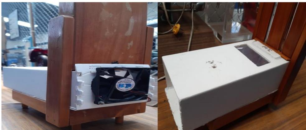
Figura 2.11. Caja de cartón pluma montada en psicrómetro de flujo continuo.
