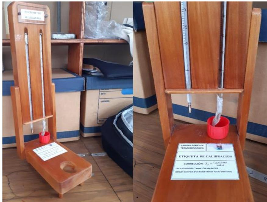
Figura 1.9. Higrómetro de bulbo seco y bulbo húmedo (psicrómetro de flujo continuo) de la FIM-EPN.
