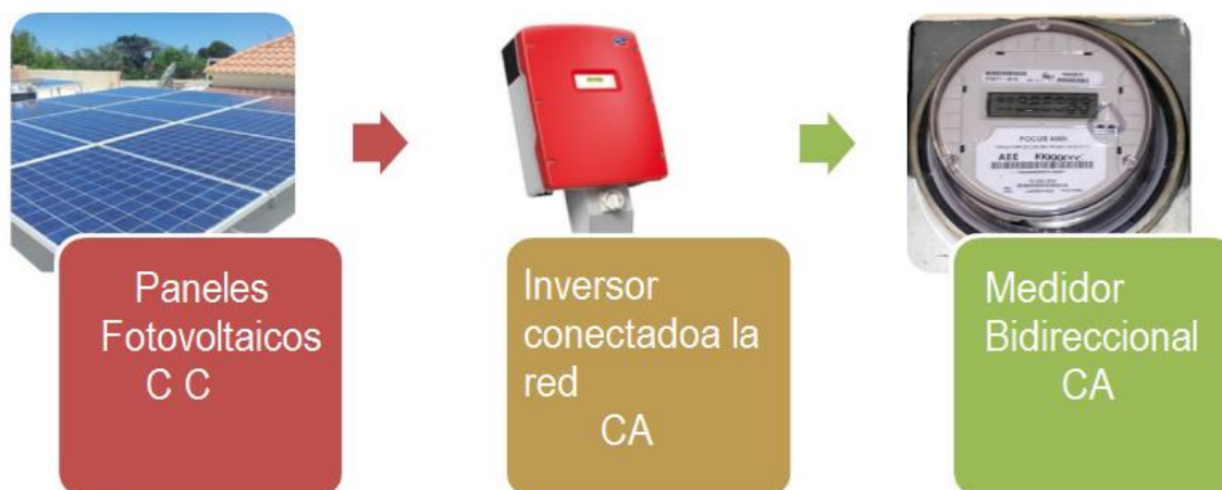
Figura 1.13. Figura del sistema fotovoltaico conectado a la red [29]
