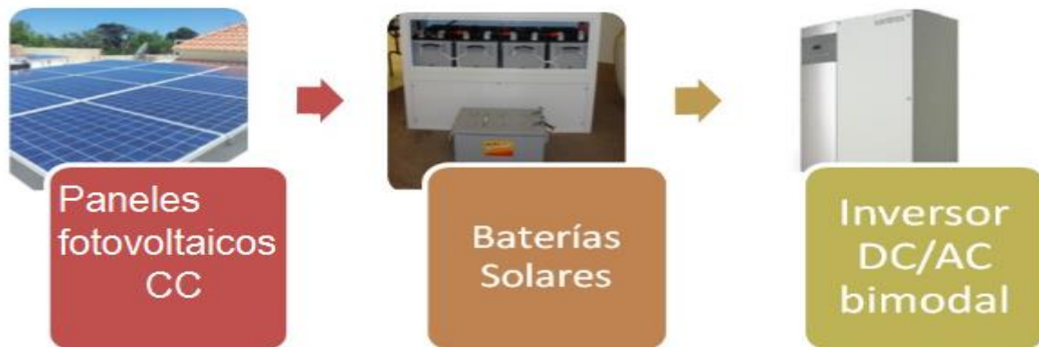
Figura 1.15. Figura del sistema fotovoltaico aislado o remoto [29]
