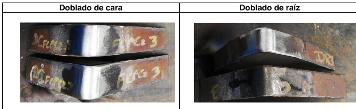
Figura 3.3. Ensayo de doblado de cara y raíz placa tres.
