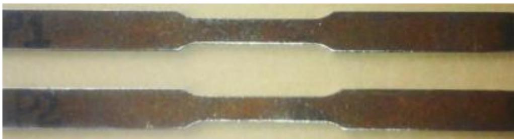
Figura 2.3. Probetas para ensayo de tensión.
