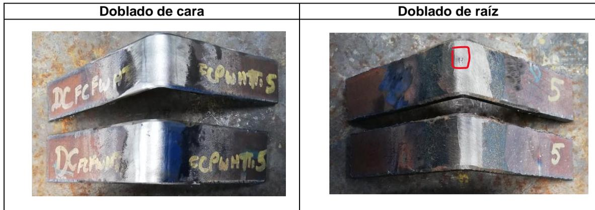
Figura 3.5. Ensayo de doblado de cara y raíz placa cinco.
