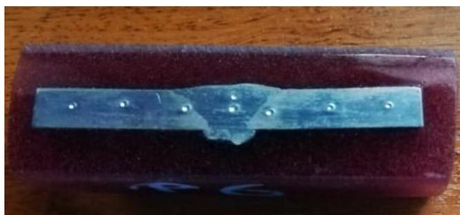
Figura 3.17. Barrido de dureza placa seis.
