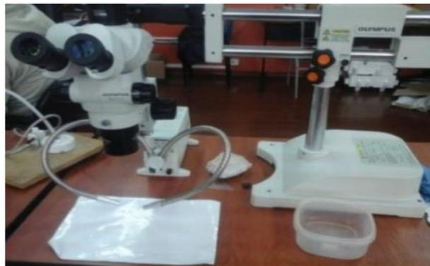
Figura 2.27. Equipo para realizar las macrografías.
