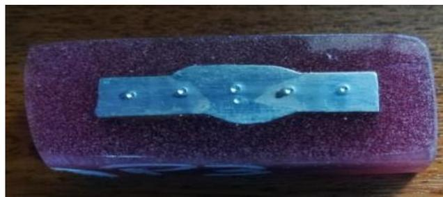
Figura 3.11. Barrido de dureza placa tres.
