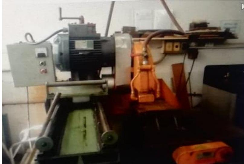
Figura 2.13. Equipo de corte por enfriamiento por agua.
