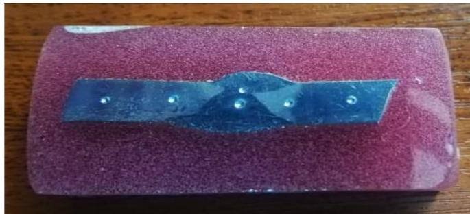
Figura 3.9. Barrido de dureza placa dos.
