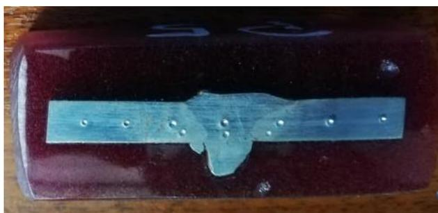
Figura 3.15. Barrido de dureza placa cinco.
