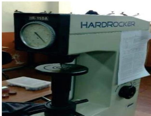
Figura 2.29. Durómetro.
