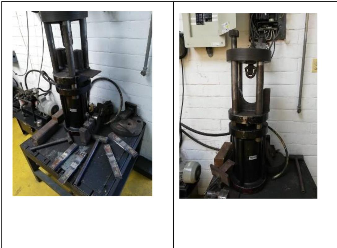
Figura 2.21. Equipo para realizar los ensayos de doblados.
