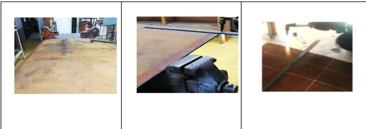
Figura 2.9. Realización de los cortes de la plancha de acero anti abrasivo grado 400HB.
