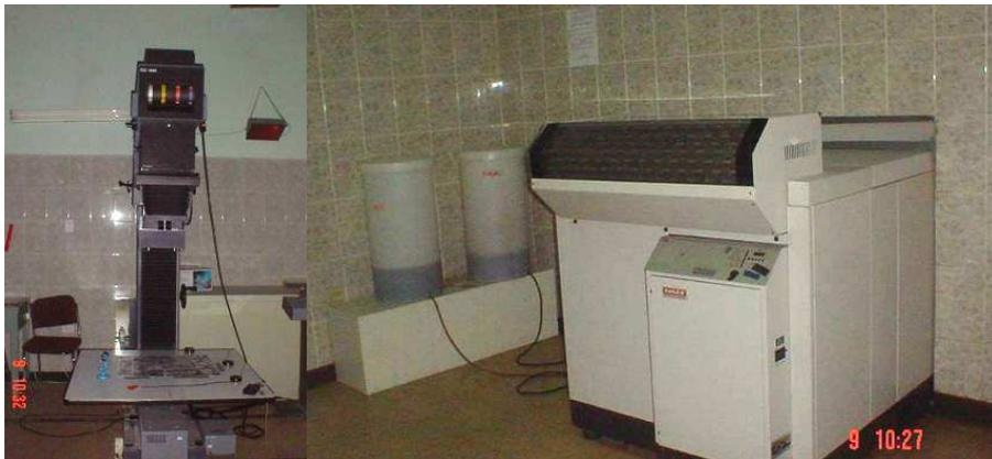
**Figura 3. 11 Ampliadora y procesadora de papel**
