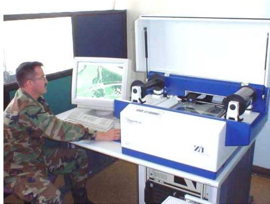
**Figura 3. 10 Escáner fotogramétrico**
