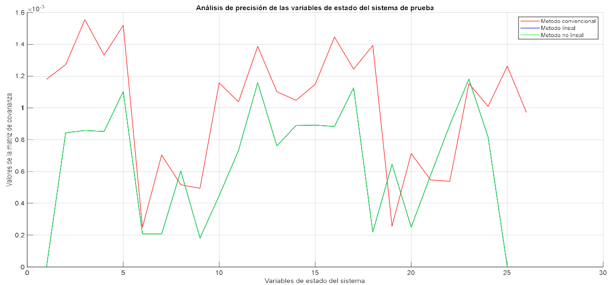
Figura 3.5 Análisis de resultados de precisión de las variables de estado del sistema, considerando los tres métodos de solución del problema de estimación de estado – sistema IEEE 14 barras
