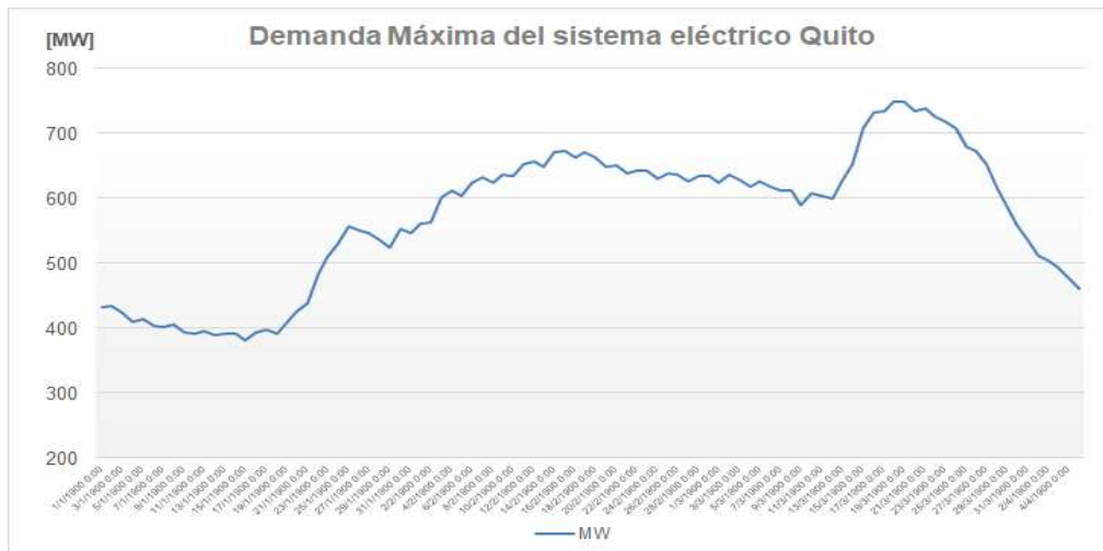
Figura 3.15 Demanda del sistema eléctrico Quito – día de demanda máxima 14 de marzo de 2018 748 MW
