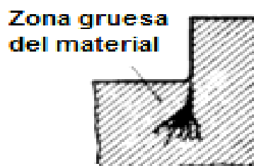
Figura 1.16. Grietas fundición. (Fuente: [17]).
