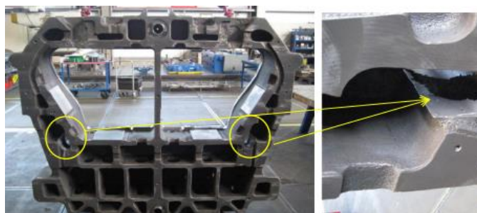
Figura 1.13. Rechupes en fundición. (Fuente: [15]).
