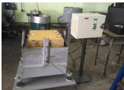
Figura 2.15. Sistema mesa vibratoria – molde. (Fuente: Propia).
