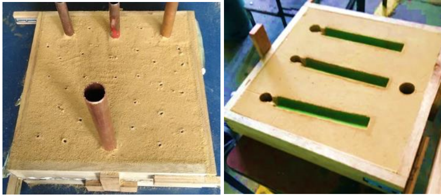
Figura 2.9. Mezcla de arena sílice con resina. Fuente: (Propia)
