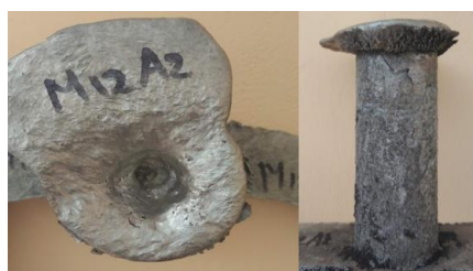
Figura 3.1 Canal de alimentación de la probeta de código M12A2, con presencia de rechufe. (Fuente: Propia).
