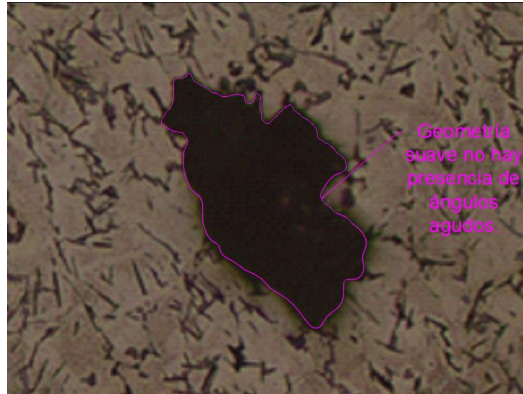
Figura 3.15 Perfil destacado de un microrechupe. (Fuente: Propia).
