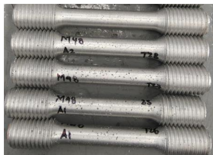
Figura 3.4. Probetas de tracción con presencia de discontinuidades. (Fuente: Propia).
