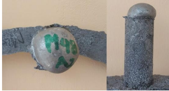
Figura 3.2 Canal de alimentación de la probeta de código M48A2, con presencia de segregación del material. (Fuente: Propia).
