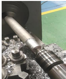
Figura 2.18. Preparación de las probetas en torno manual. (Fuente: Propia).
