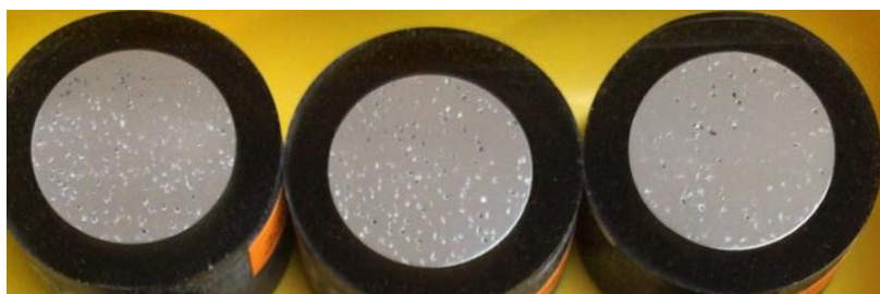
Figura 3.5 Probetas de microestructura con presencia de discontinuidades. (Fuente: Propia).
