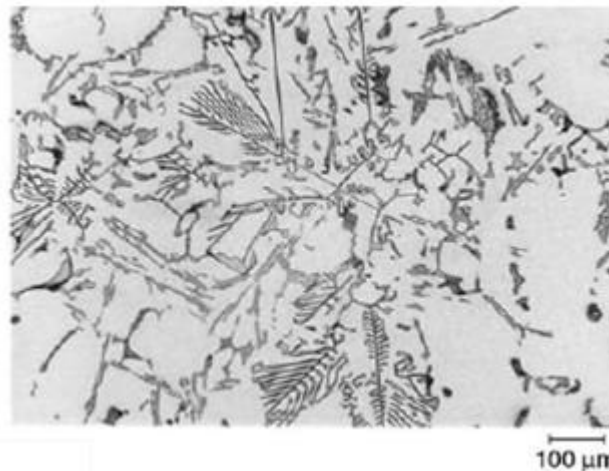
Figura 1.5. Aleación de aluminio-silicio hipoeutéctica (Al-5.7Si). (Fuente: [10])
