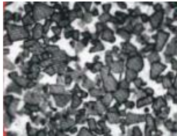
Figura 1.6 Micrografía electrónica del níquel TD dispersas de ThO 2 , con partículas de 300nm.
