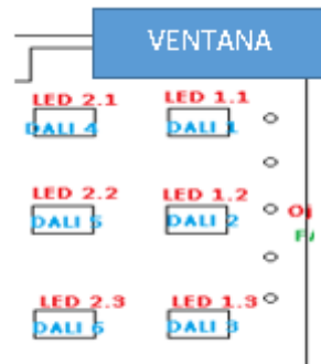
Figura 3.9. Dimerización Luminarias Aula de Clases
