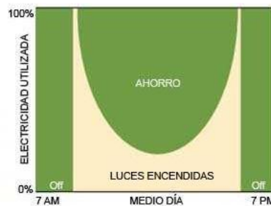
Figura 3.18. Ahorro producido por Ajuste de Atenuación de las luminarias
