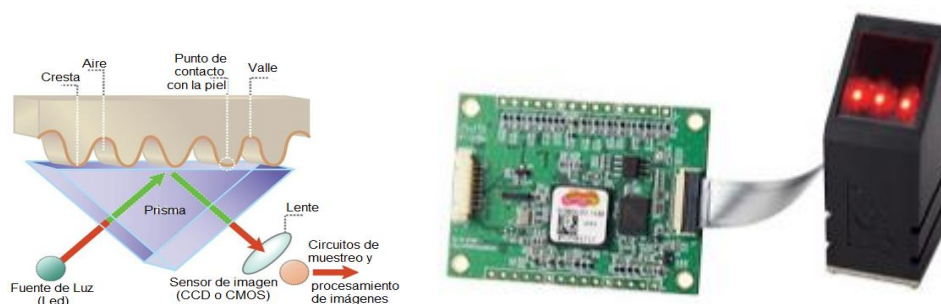
Figura 1.24. Sensor dactilar óptico [14]
