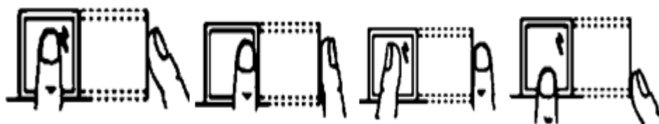
Figura A.8. Formas incorrectas de colocación de huella digital
