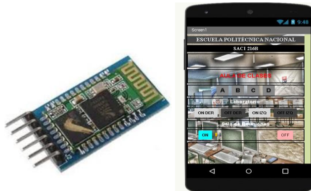
Figura 3.17. Módulo de comunicación Bluetooth HC-05 [45].
