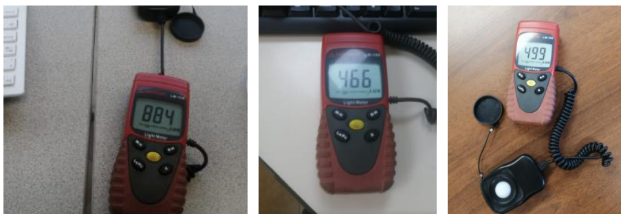
Figura 3.4. Medición de niveles de iluminación en Salón 216B
