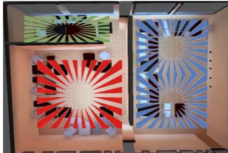
Figura A.10. Cobertura sensores de movimiento
