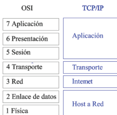
Figura 1.19 Correspondencia entre capas de los modelos OSI y TCP/IP [17]
