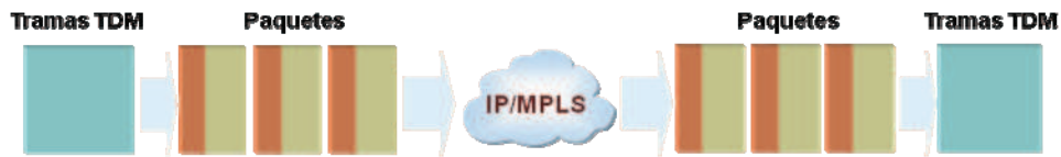
Figura 2.23 Funcionamiento de TDMoIP [73]
