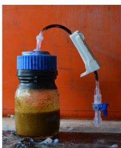
**Imagen 1.** Biorreactor con lodo anaerobio
