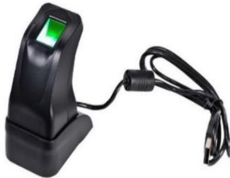
Figura 1.4 Enrolador de huella dactilar ZK4500. Fuente: (TOP SECURITY PERU, s.f.).
