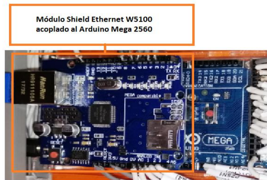
Figura 3.5 Módulo Shield Ethernet acoplado al Arduino Mega 2560.
