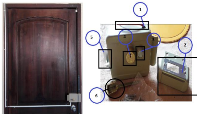
Figura 3.34 Cerradura eléctrica y sus partes.
