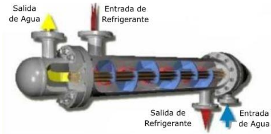
Figura 11. Condensador multitubular horizontal. (Fuente: https://docit.tips/download/tiposcondensadores_pdf [8].)
