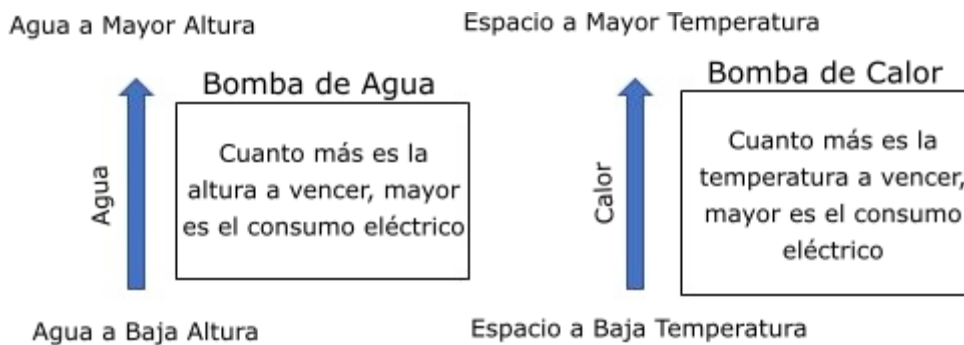
Figura 1. Analogía entre bomba de agua y bomba de calor que utilizan energía eléctrica. (Fuente: Urchueguía 2013) (Elaboración: Propia)
