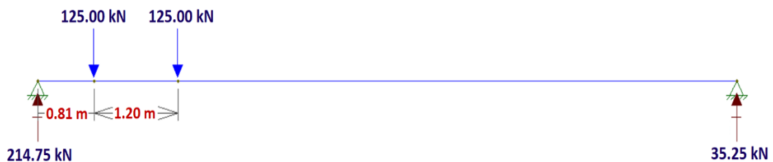
FIGURA 4.72 Posición del tándem para sección crítica de corte
