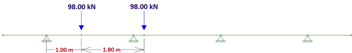
FIGURA 4.17 Condición crítica de un carril cargado.
