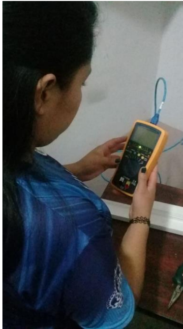
Figura 3.26. Pruebas de continuidad y voltaje en cables.
