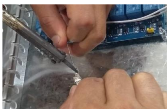
Figura 3.33. Estañado de los terminales del cable 20AWG.
