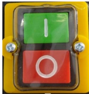
Figura 3.12. Pulsadores NA y NC Fuente: Propia
