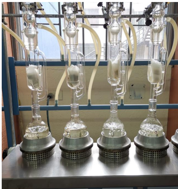
Detalle de los capuchones en el equipo de Soxhlet
