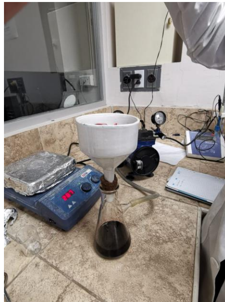
Filtrado por succión de la muestra
