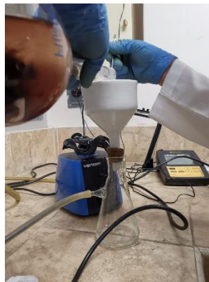
Secado de los filtros con la muestra
