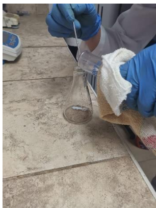
Lavado del residuo con agua caliente
