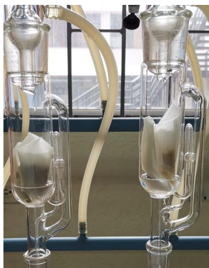
Detalle de los capuchones en el equipo de Soxhlet
