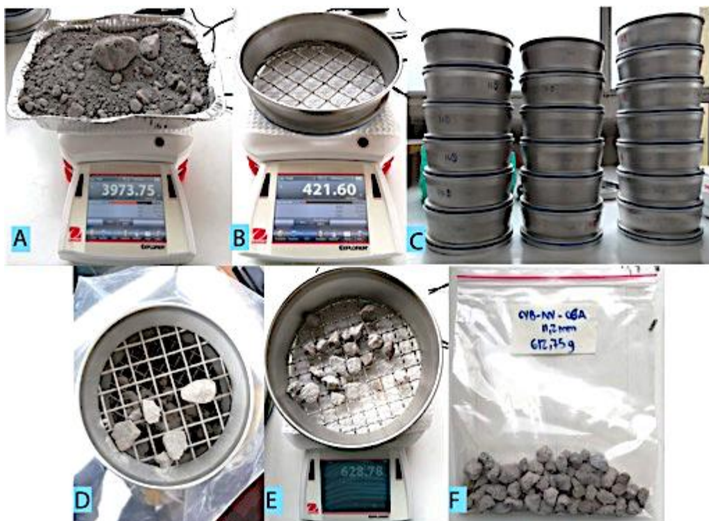
Figura 21. Procedimiento para el ensayo de granulometría.
