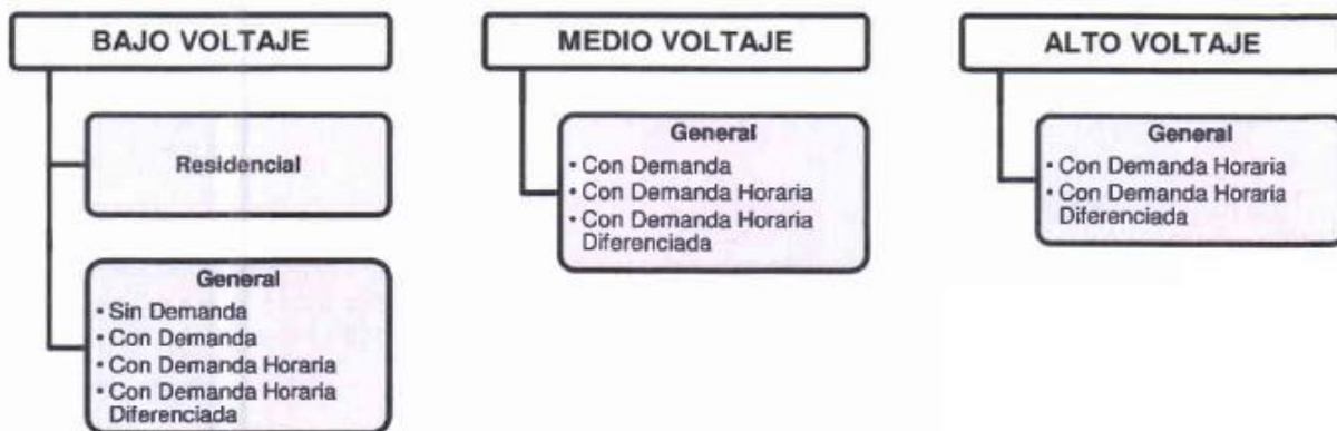
Figura 2.27. Clasificación de los usuarios según su demanda y su nivel de voltaje [56]
