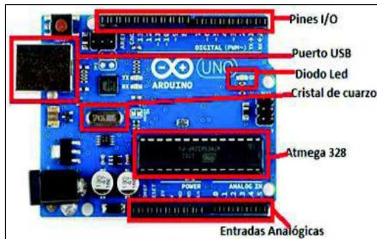
Figura 1. 3 Módulo Arduino – Descripción de partes [5]
