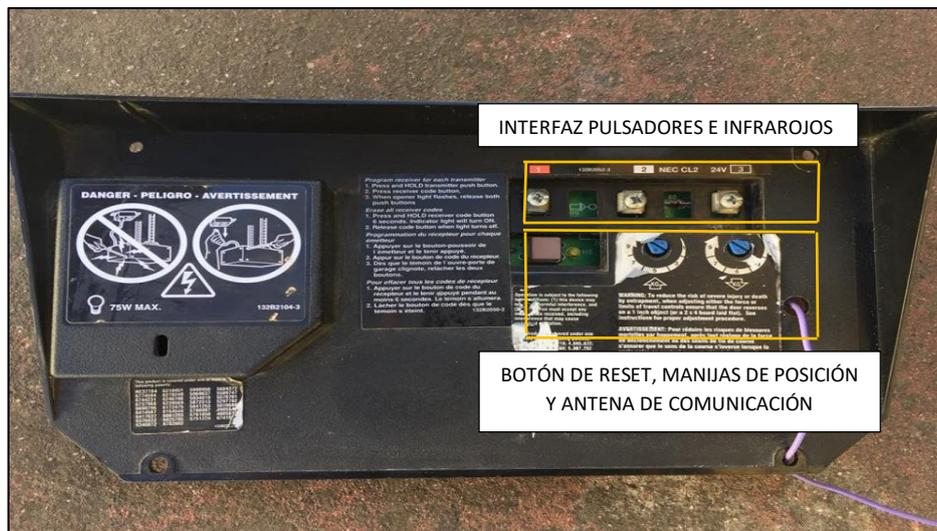
Figura 3. 3 Interfaces externas de motor de Garage
