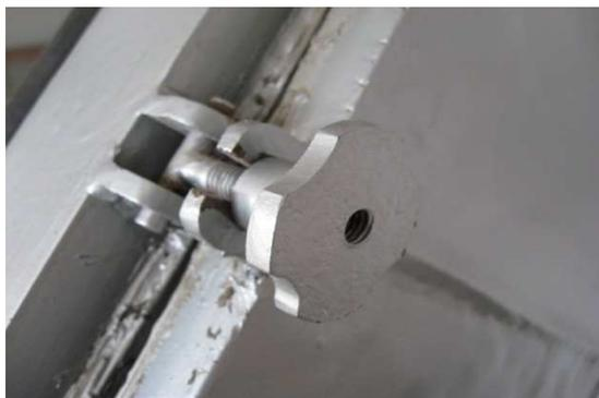
**Figura 3.3** Perno de sujeción manual de la puerta.
