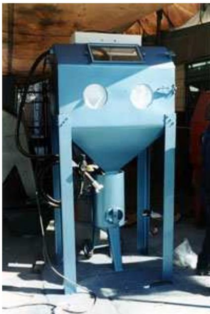
**Figura 2.4** Equipo de sand blasting por succión.
