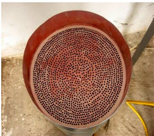
Figura 3.5 Tamiz: Evita el paso de partículas que puedan taponar el sistema.
