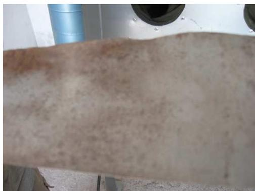
**Figura 5.5** Probeta sometida a chorro abrasivo de arena.
