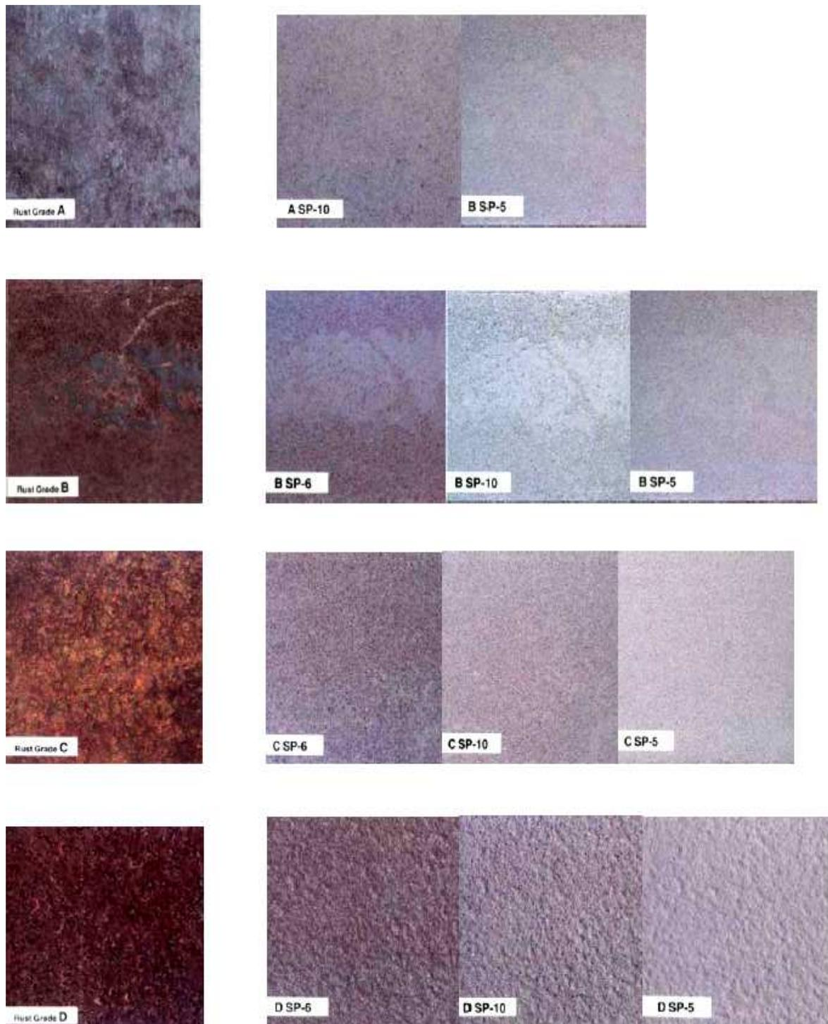
Figura 2.7 Grados de preparación de superficies<sup>17</sup>.
