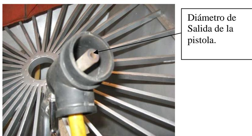
**Figura 3.7** Salida de abrasivo de la pistola.
