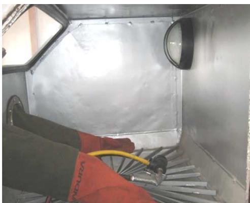
**Figura 5.7 Partes internas de la cabina expuestas a desgaste.**
