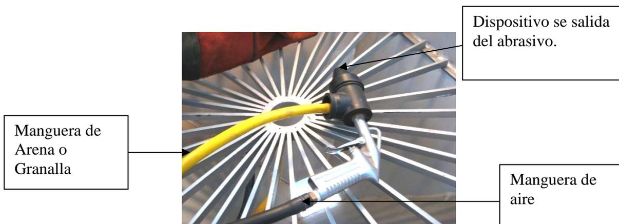
**Figura 3.6** Pistola utilizada en el sistema sand blasting.
