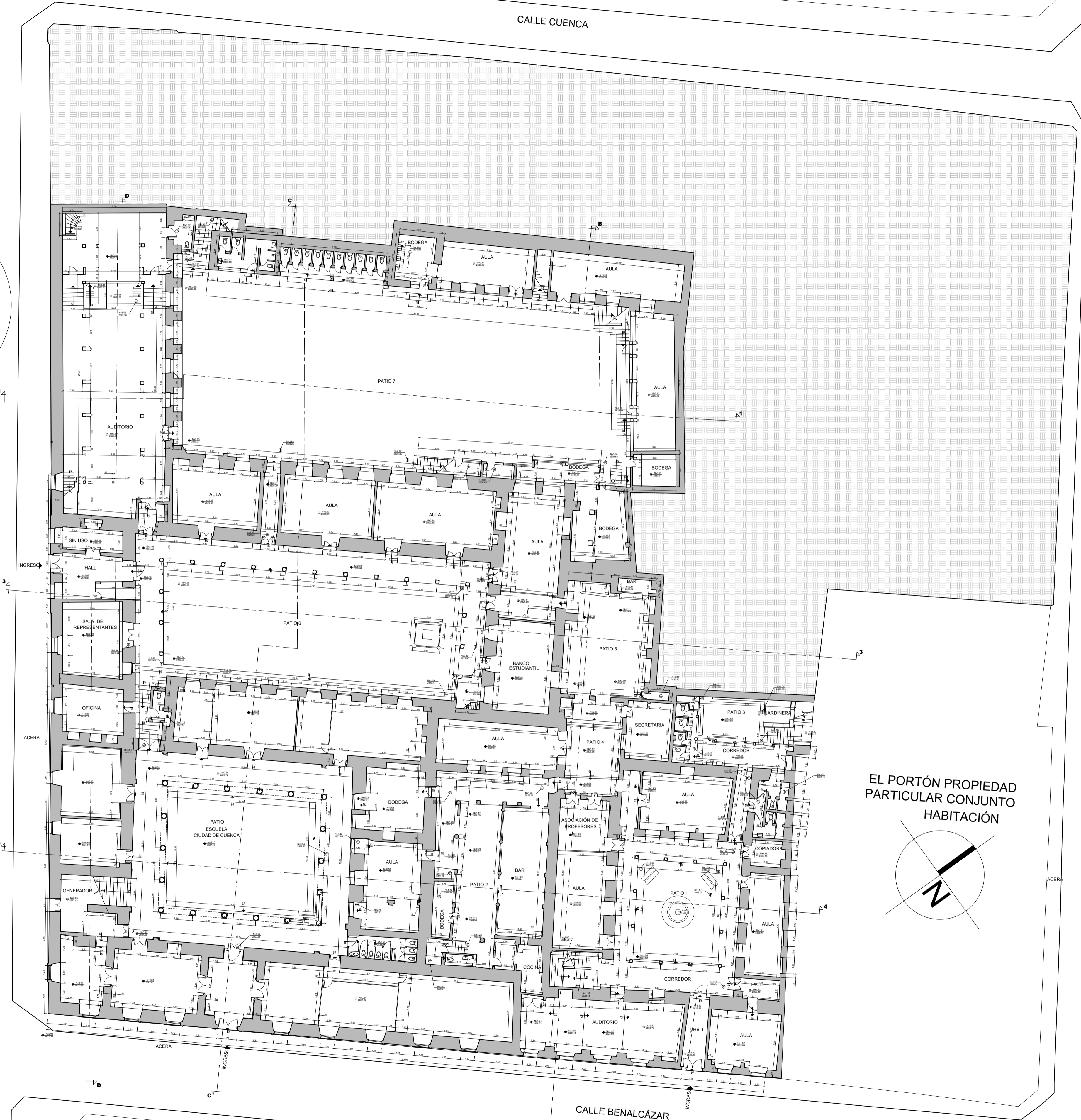
ACTUALIZACIÓN DE LEVANTAMIENTO - PLANTA BAJA NIVELES +0.10;+0.58;+1.60 - MANZANA SIMÓN BOLIVAR
