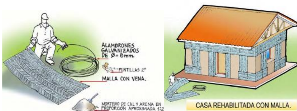
FIGURA 2.6: Alternativa de reforzamiento III
