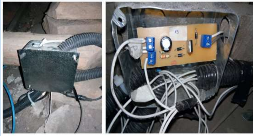
Figura 3.41: Ubicación de las placas electrónicas en cajetines Fuente: Propia
