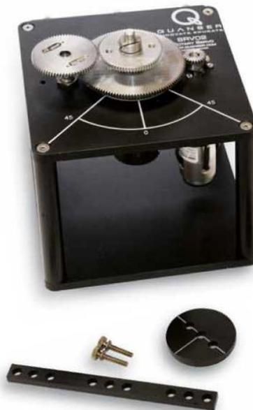
Figura. 2.1. Máquina para enseñanza de teorías de control marca Quanser.
