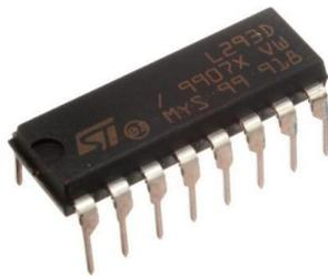
Figura 1.1. Diagrama del driver L293D.
