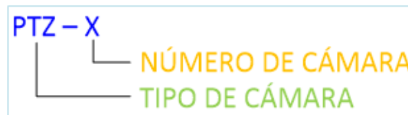
Figura 3.9 Codificación para etiquetado de cámaras
